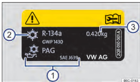
Fig. 226 Información del aire acondicionado.
