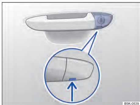
Fig. 55 Manilla de la puerta del conductor: bombín de cierre cubierto.
