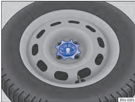
Fig. 213 En el maletero: manivela para fijación de la rueda de emergencia.
