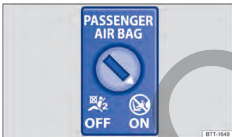
Fig. 39 En el panel de instrumentos en el lado del acompañante delantero: interruptor accionado por la llave para desconectar y conectar el airbag frontal del acompañante delantero.
