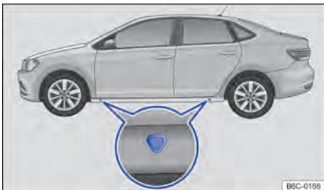
Fig. 219 Puntos de apoyo del gato.
