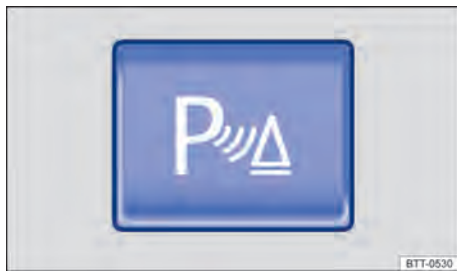
Fig. 101 En la consola central: tecla de encender y apagar la ayuda de estacionamiento (dependiendo de la versión del vehículo).
