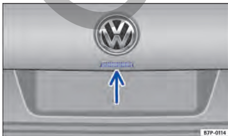
Fig. 60 En la tapa trasera: botón para abrir la tapa trasera.
