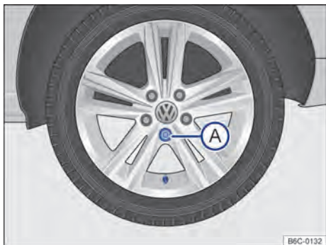
Fig. 215 Retire el tapacubos integral.
