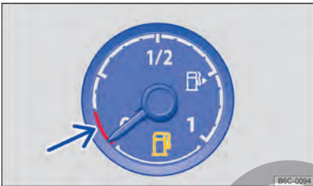
Fig. 12 En el instrumento combinado analógico: indicador del nivel de combustible.
