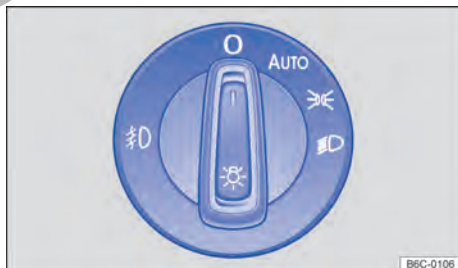
Fig. 73 Al lado del volante: interruptor de luces (una variante).
