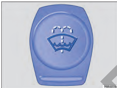
Fig. 201. En el compartimento del motor: tapa del tanque de agua de los lavaparabrisas.
