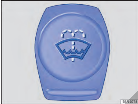
Fig. 144 En el compartimento del motor: tapa del tanque de agua de los lavaparabrisas.
