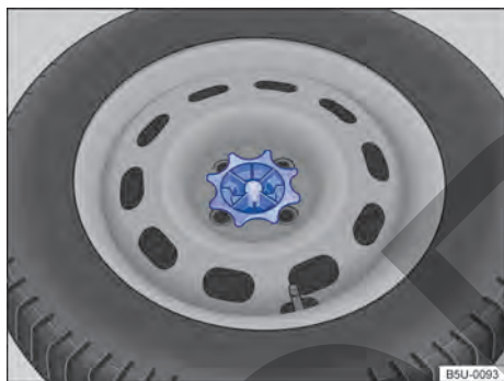
Fig. 156 En el maletero: manivela para fijación de la rueda de emergencia.
