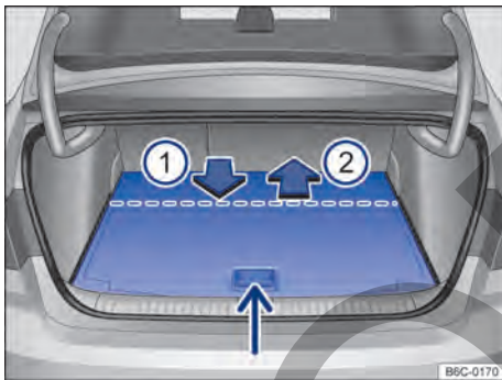
Fig. 111 En el maletero: regular la altura del piso variable del maletero.
