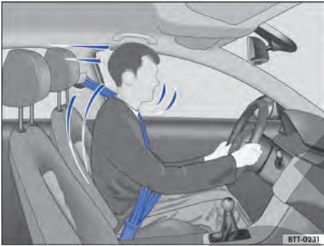
Fig. 29 Conductor protegido por el cinturón de seguridad correctamente colocado en una maniobra de frenado súbito.
