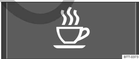
Fig. 18 En el display del instrumento combinado: símbolo del sistema de reconocimiento de cansancio.
