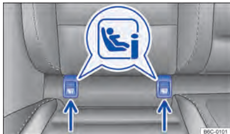
Fig. 43 En el asiento del vehículo: identificación de los puntos de anclaje inferiores de asientos para niños.
