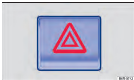
Fig. 47 En la parte superior de la consola central: interruptor de las luces de advertencia.
