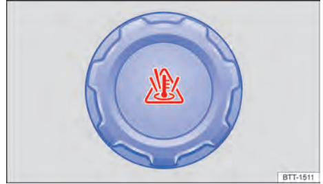
Fig. 148 En el compartimento del motor: tapa del depósito de expansión del líquido refrigerante del motor.
