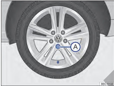
Fig. 158 Retire el tapacubos integral.
