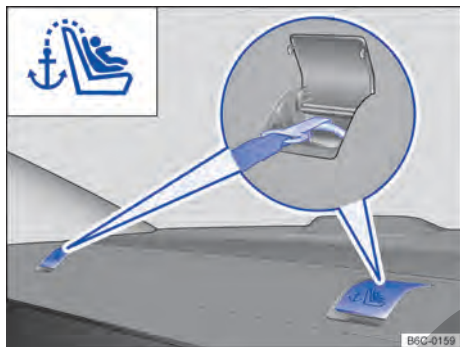
Fig. 44 Ojales de retención para el cinturón de fijación superior en la cubierta del maletero.
