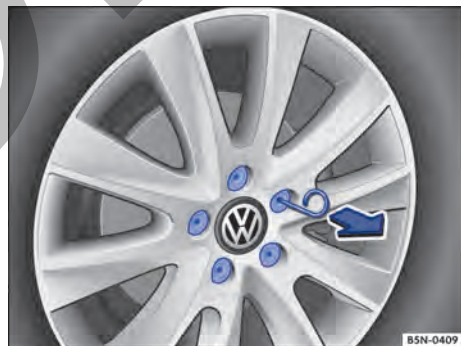
Fig. 159 Retirar las caperuzas de los tornillos de la rueda.
