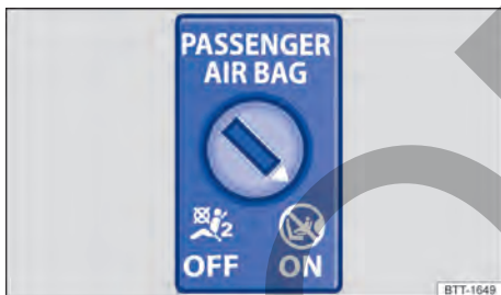
Fig. 38 En el panel de instrumentos en el lado del acompañante delantero: interruptor accionado por la llave para desconectar y conectar el airbag frontal del acompañante delantero.
