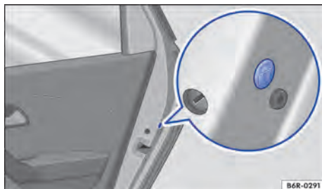
Fig. 56 En la puerta trasera: cierre de emergencia, cubierto por una junta de goma.
