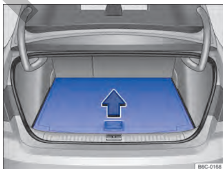
Fig. 110 En el maletero: levantar el piso variable del maletero.
