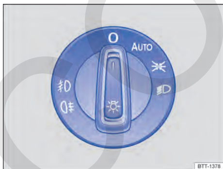
Fig. 100 Junto al volante: mando de las luces (una variante).
