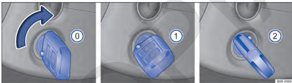
Fig. 121 Junto al volante, en el lado derecho: posiciones de la llave del vehículo en la cerradura de encendido.
