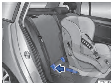
Fig. 56 Representación esquemática: montaje de un asiento para niños ISOFIX con conectores.
