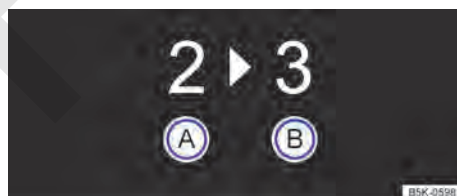
Fig. 118 En la pantalla del cuadro de instrumentos: recomendación de marcha.
