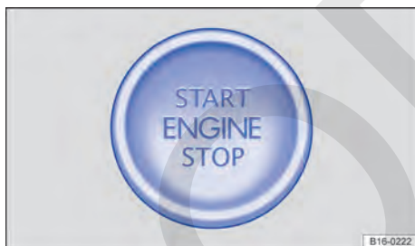
Fig. 122 En la parte inferior de la consola central: pulsador de encendido y arranque para poner el motor en marcha.
