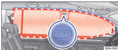
Fig. 48 En el lado izquierdo del vehículo (5 plazas): ubicación y zona de despliegue del airbag para la cabeza.
