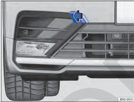
Fig. 227 En el lado derecho del paragolpes delantero: tapa del alojamiento de la argolla de remolque.
