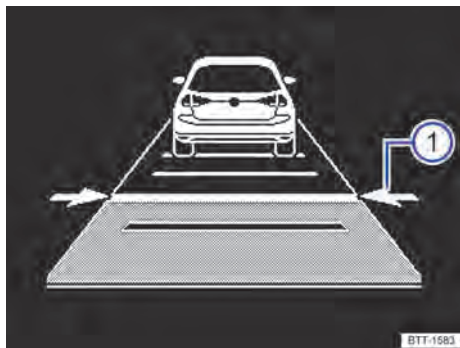
Fig. 146 En la pantalla del cuadro de instrumentos: ajustar la distancia ① (representación esquemática, el ACC regula).
