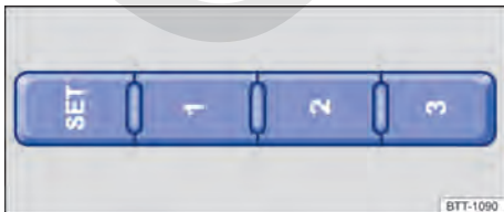
Fig. 94 En el lateral exterior del asiento del conduc-tor: teclas de memoria.
