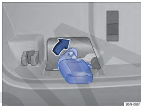
Fig. 75 En el maletero: desbloqueo de emergencia del portón del maletero.
