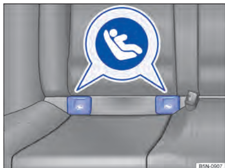
Fig. 55 En el asiento del vehículo: señalización de los puntos de anclaje ISOFIX para los asientos para niños.
