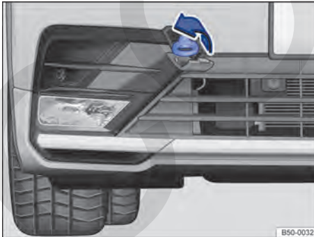
Fig. 228 En el lado derecho del paragolpes delantero: enroscar la argolla de remolque.
