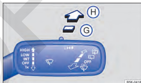
Fig. 106 En el lado derecho de la columna de dirección: manejo del limpiacristales.
