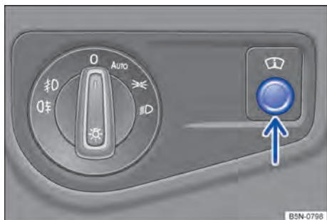
Fig. 15 Junto al volante: regulador del Head-up-Display (flecha).
