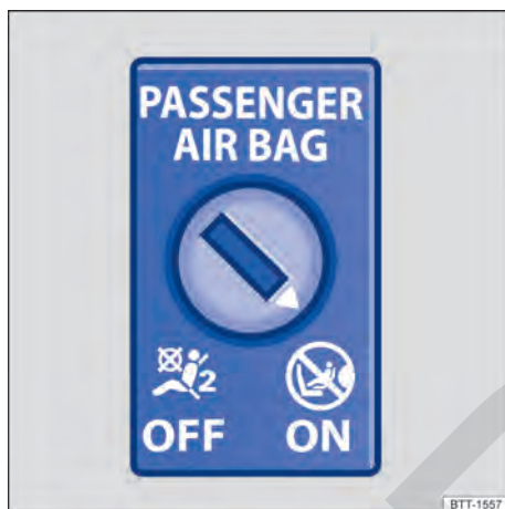
Fig. 45 En el tablero de instrumentos del lado del acompañante o en la guantera: conmutador de llave para activar y desactivar el airbag frontal del acompañante.
