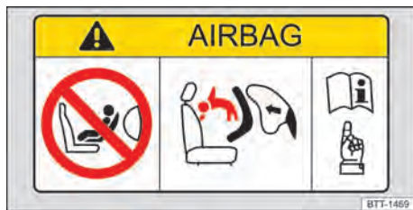
Fig. 53 Representación esquemática: etiqueta adhesiva relativa al airbag en el parabrisol.
