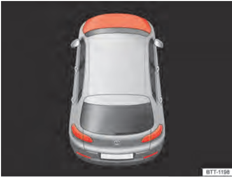
Fig. 231 En la pantalla del cuadro de instrumentos: capó del motor abierto o no cerrado correctamente (representación esquemática).
