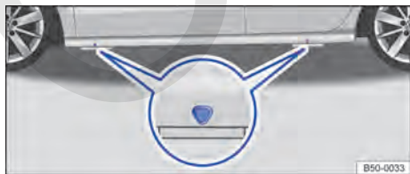
Fig. 252 Puntos de apoyo para el gato.
