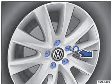
Fig. 249 Retirar las caperuzas de los tornillos de rueda.
