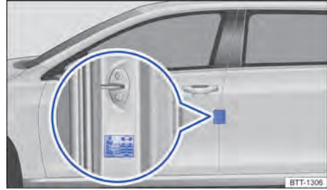
Fig. 243 En el pilar de la puerta del conductor: adhesivo de la presión de los neumáticos (o en el lado interior de la tapa del depósito de combustible).
