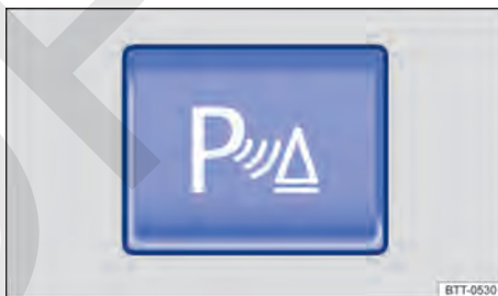
Fig. 152 En la consola central: tecla para conectar y desconectar la ayuda de aparcamiento (en función del equipamiento).
