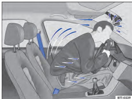
Fig. 34 El conductor sin el cinturón de seguridad colocado sale lanzado hacia adelante.
