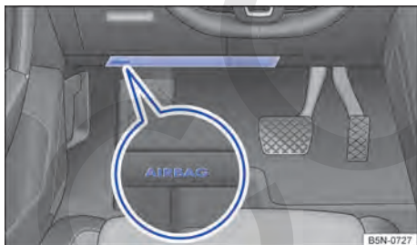
Fig. 50 En el lado del conductor: ubicación del airbag para las rodillas.
