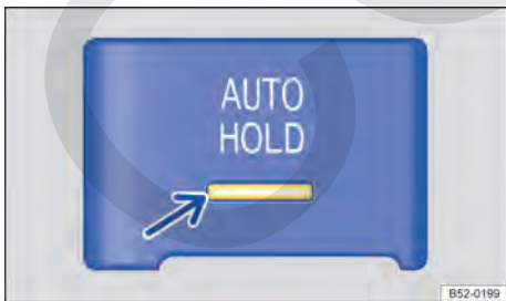
Fig. 151 En la consola central: tecla de la función Auto-Hold.
