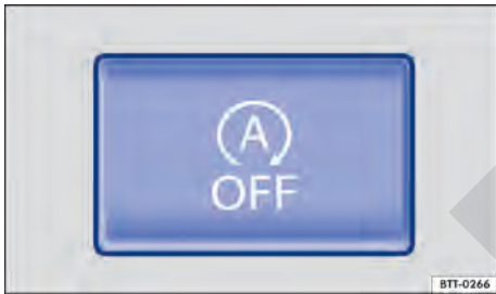
Fig. 124 En la parte inferior de la consola central: tecla del sistema Start-Stop.
