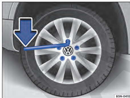
Fig. 250 Cambio de rueda: aflojar los tornillos de rueda.
