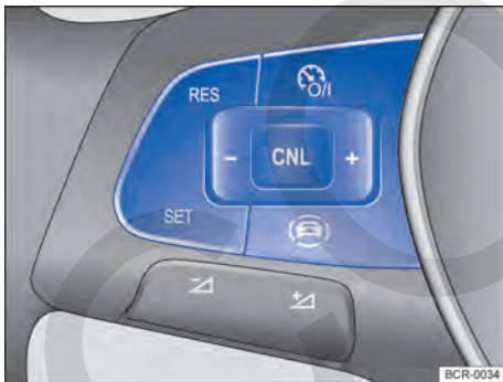
Fig. 141 Lado izquierdo del volante multifunción: teclas para manejar el limitador de velocidad.
