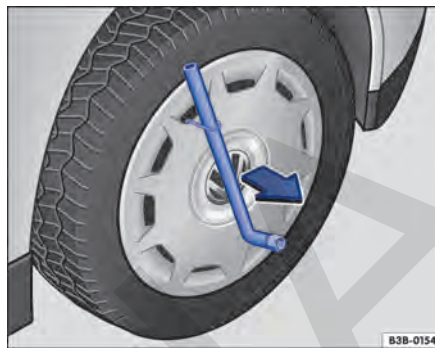
Fig. 248 Desmontar el tapacubos integral.
