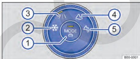
Fig. 132 En la parte inferior de la consola central: mando del 4MOTION Active Control en vehículos con tracción total.
