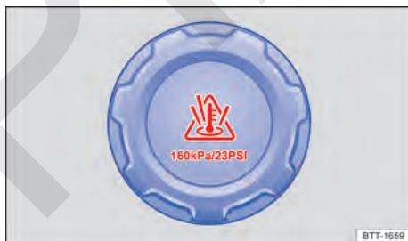
Fig. 236 En el vano motor: tapa del depósito de expansión del líquido refrigerante del motor (representación esquemática).
