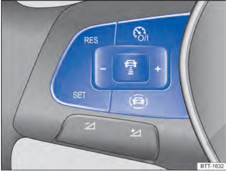
Fig. 145 Lado izquierdo del volante multifunción: teclas para manejar el ACC.
