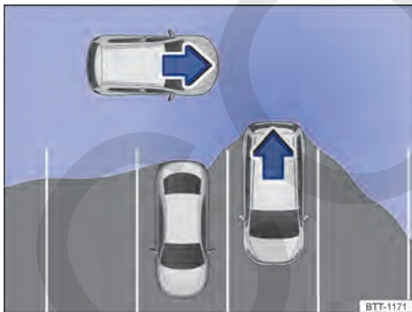
Fig. 161 Representación esquemática del asistente de salida del aparcamiento: zona vigilada alrededor del vehículo que está desaharcando.
