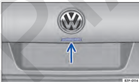
Fig. 71 En el portón del maletero: pulsador para abrir el portón.
