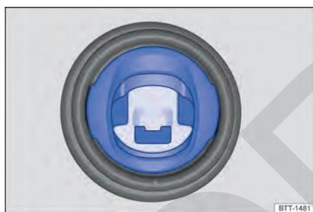
Fig. 201 En la boca de llenado del depósito de combustible: protección contra repostaje equivocado.
