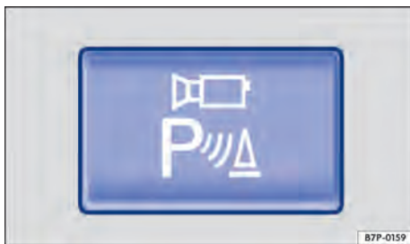
Fig. 159 En la consola central: tecla para conectar manualmente el sistema de visión periférica.
