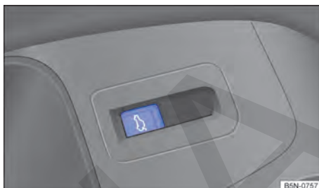
Fig. 70 En la puerta del conductor: tecla de desbloqueo del portón del maletero (en función del equipamiento).
