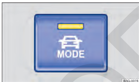
Fig. 131 En la parte inferior de la consola central: tecla de selección del perfil de conducción.
