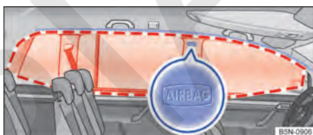
Fig. 49 En el lado izquierdo del vehículo (7 plazas): ubicación y zona de despliegue del airbag para la cabeza.
