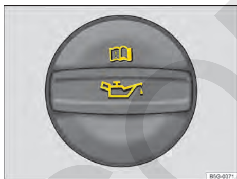
Fig. 234 En el vano motor: tapa de la boca de llenado de aceite del motor (representación esquemática).
