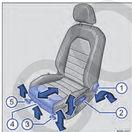
Fig. 80 En el asiento delantero izquierdo: mandos (variante 2).
