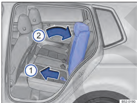
Fig. 85 Ajuste del respaldo del asiento trasero.
