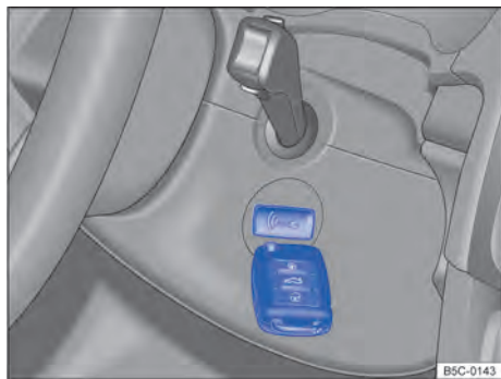
Fig. 123 En el lado derecho de la columna de dirección: función de arranque de emergencia en los vehículos con el sistema de cierre y arranque sin llave "Keyless Access".
