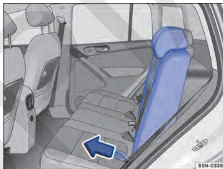
Fig. 86 Abatir y levantar el respaldo del asiento trasero.
