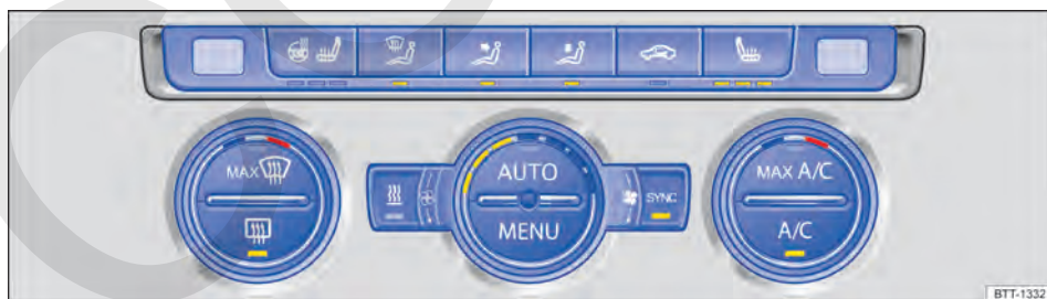
Fig. 114 En la parte superior de la consola central: panel de mandos del Climatronic.
