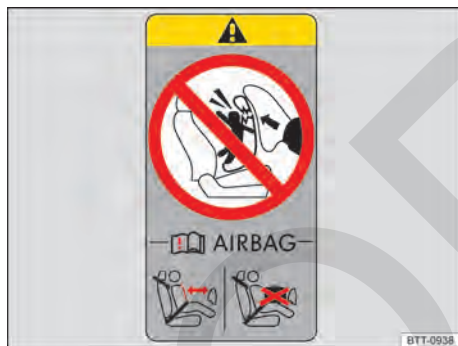
Fig. 54 Representación esquemática: etiqueta adhesiva relativa al airbag en el pilar B.
