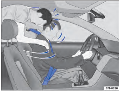
Fig. 35 El ocupante del asiento trasero sin el cinturón de seguridad colocado sale lanzado hacia delante topando contra el conductor, que sí lo lleva colocado.
