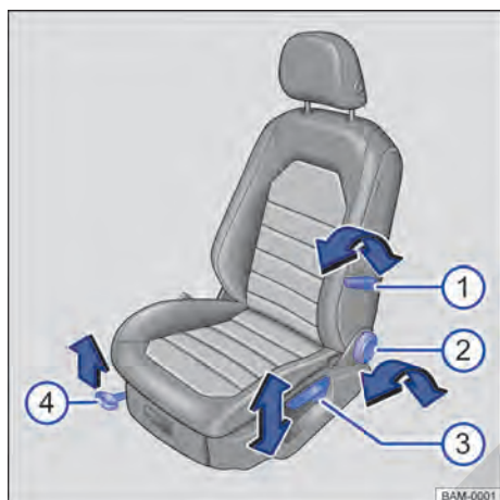
Fig. 79 En el asiento delantero izquierdo: mandos (variante 1).
