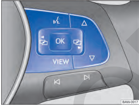
Fig. 25 Lado derecho del volante multifunción: teclas para utilizar los menús y las indicaciones informativas del cuadro de instrumentos.
