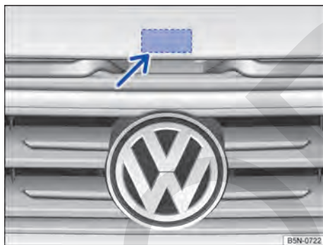
Fig. 230 Encima de la parrilla del radiador: palanca de accionamiento del capó del motor.
