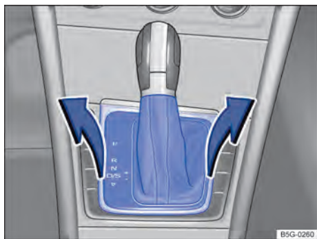
Fig. 129 Desmontar la cubierta de la corredera de la palanca selectora.
