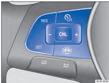
Fig. 139 Lado izquierdo del volante multifunción: teclas para manejar el regulador de velocidad.
