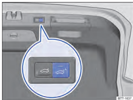
Fig. 74 En el portón del maletero abierto: tecla para el cierre eléctrico del portón.
