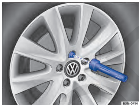
Fig. 254 Cambio de rueda: desenroscar los tornillos de rueda con el mango del destornillador.
