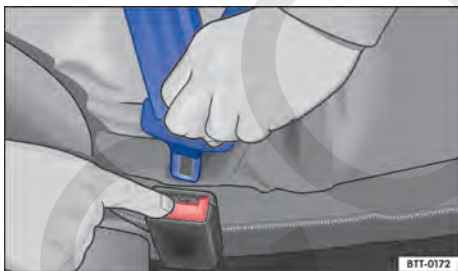
Fig. 38 Soltar la lengüeta del cierre del cinturón.
