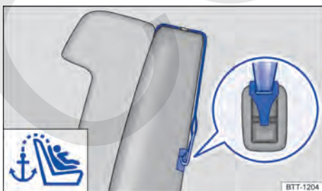
Fig. 57 En la parte posterior de la segunda fila de asientos: argolla de sujeción para el cinturón de fijación superior.
