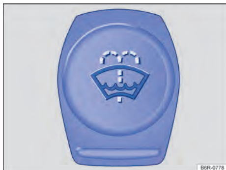
Fig. 232 En el vano motor: tapa del depósito del líquido lavacrystales.
