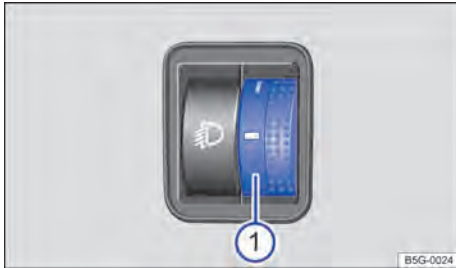
Fig. 103 Junto al volante: regulador del alcance de las luces ①.
