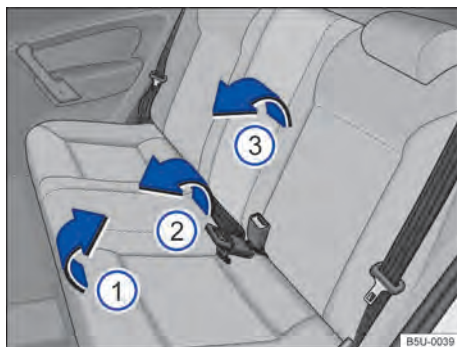
Fig. 58 Asiento trasero: inclinar el asiento trasero.
