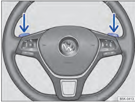
Fig. 86 Volante con selectores basculantes de Tiptronic.
