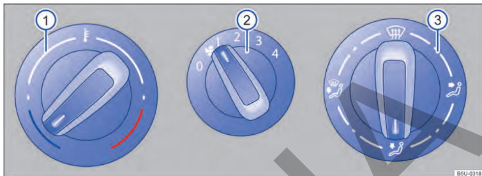
Fig. 72 Mandos del sistema de ventilación y calefacción.
