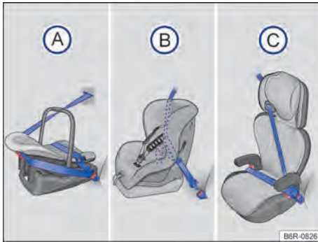
Fig. 35 Las ilustraciones (A), (B) y (C) muestran la fijación del sistema de retención infantil sólo con el cinturón de seguridad del vehículo.
