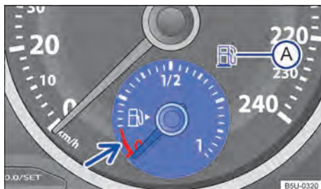
Fig. 13 En el panel de instrumentos: indicador del nivel de combustible (variante 2).
