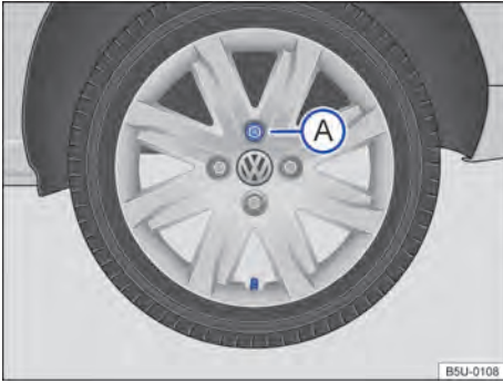
Fig. 145 Cambio de rueda: secuencia de desmontaje de los tornillos de la rueda.
