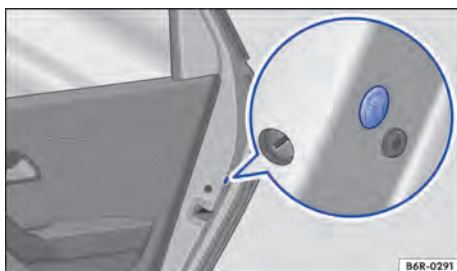
Fig. 51 En la puerta trasera: cierre de emergencia, cubierto por un burlete de goma. ▶
