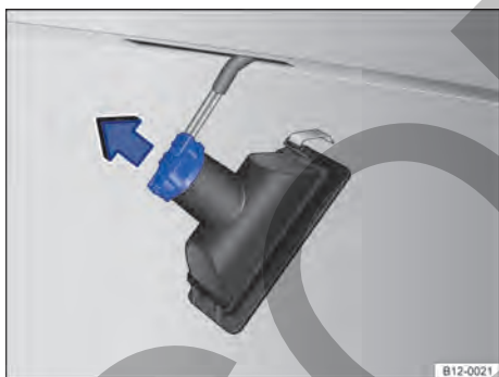
Fig. 116 Luz de la placa de licencia: retirar el portalámparas.
