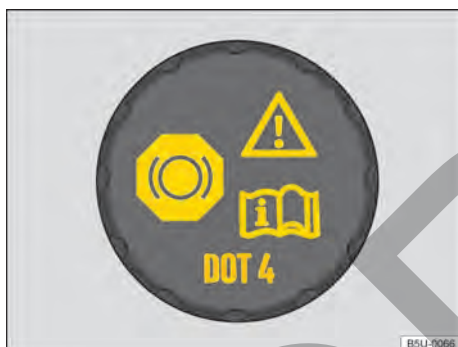
Fig. 132 En el compartimento del motor: tapón de cierre del depósito del líquido de frenos.
