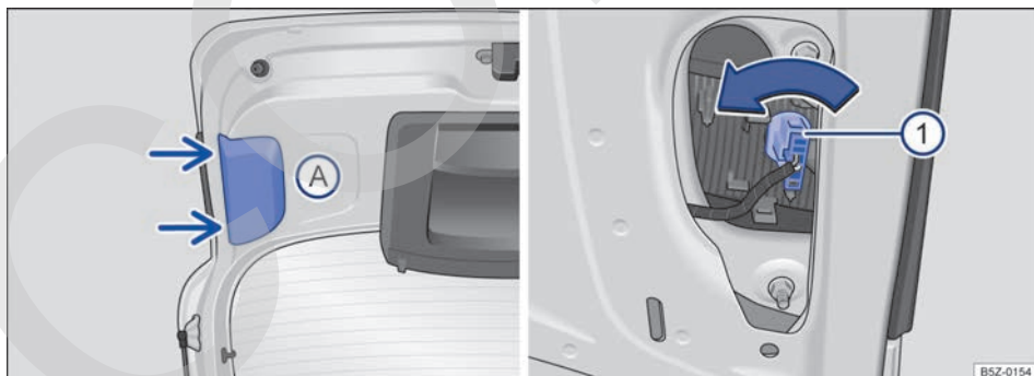
Fig. 146 En la tapa trasera: desmonte la cubierta de la lámpara de la linterna derecha y/o de la linterna trasera izquierda - para vehículos sin linterna de neblina. ▶
