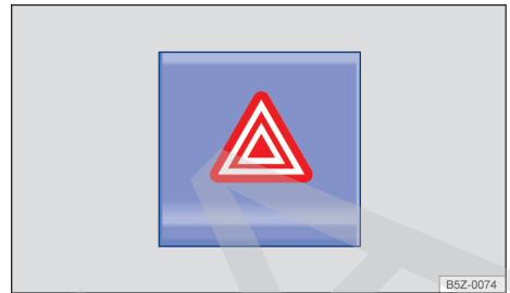
Fig. 23 En la parte superior de la consola central: interruptor de encender y apagar las luces de advertencia.
