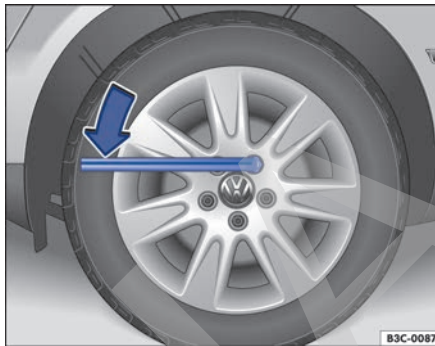
Fig. 183 Cambio de rueda: aflojar los tornillos de la rueda.
