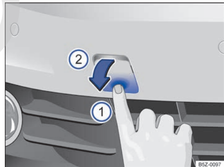
Fig. 158 En el parachoques delantero a la derecha: suelte y desmonte la cubierta. ▶
