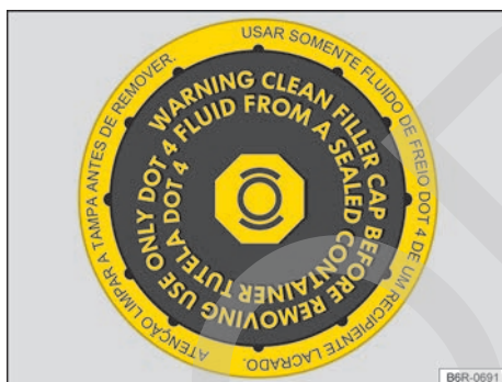
Fig. 171 En el compartimento del motor: tapón de cierre del depósito del líquido de frenos (variante 1).
