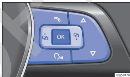
Fig. 47 Lado derecho del volante multifunción: teclas de comando.
