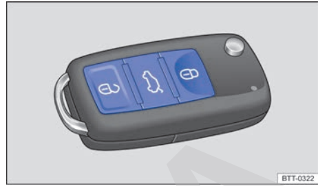
Fig. 53 Teclas en la llave del vehículo con mando a distancia.
