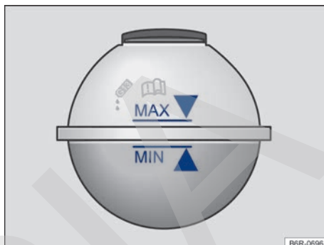
Fig. 169 En el compartimento del motor: marca en el depósito de expansión del líquido refrigerante del motor.
