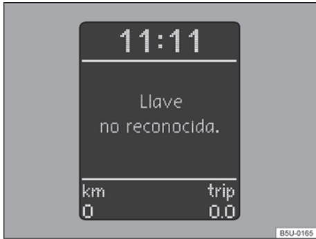
Fig. 98 En el panel de instrumentos: display con indicación del inmovilizador activado - vehículos con Sistema de Informaciones Volkswagen.
