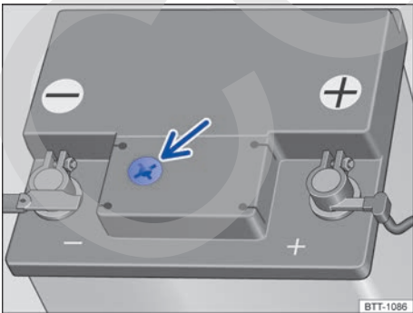
Fig. 201 Representación esquemática: mirilla en la parte superior de la batería de 12 voltios.
