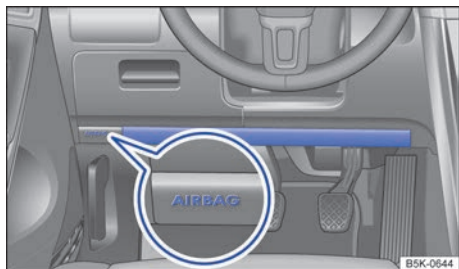
Fig. 21 En el lado del conductor: ubicación del airbag para las rodillas.
