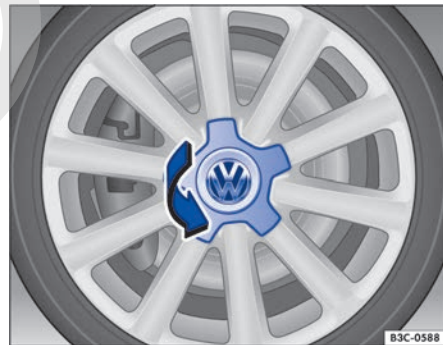
Fig. 209 Desmontar el tapacubos central girándolo.
