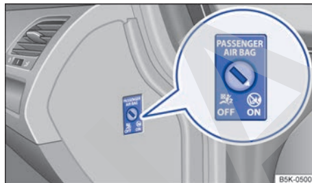
Fig. 17 En el tablero de instrumentos del lado del acompañante: conmutador de llave para activar y desactivar el airbag frontal del acompañante.
