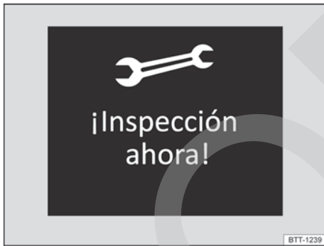
Fig. 44 En la pantalla del cuadro de instrumentos: ejemplo de visualización de un aviso de servicio (representación esquemática).
