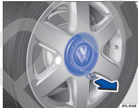
Fig. 208 Desmontar el tapacubos central tirando de él.
