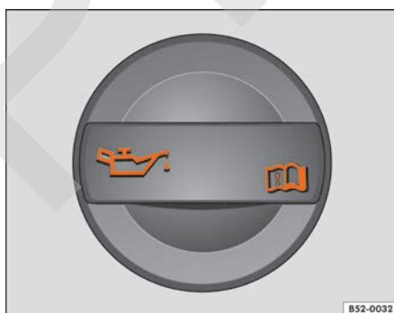
Fig. 197 En el vano motor: tapa de la boca de llenado de aceite.
