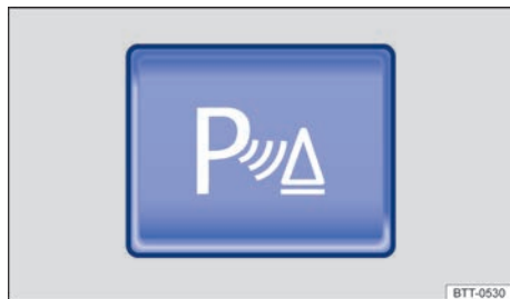
Fig. 127 En la consola central: tecla para conectar y desconectar el ParkPilot.
