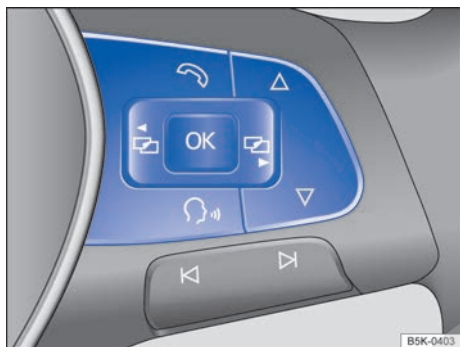
Fig. 47 Lado derecho del volante multifunción: teclas para utilizar los menús y las indicaciones informativas del cuadro de instrumentos.
