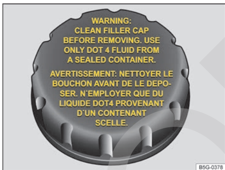
Fig. 195 En el vano motor: tapa del depósito del líquido de frenos (variante 2).
