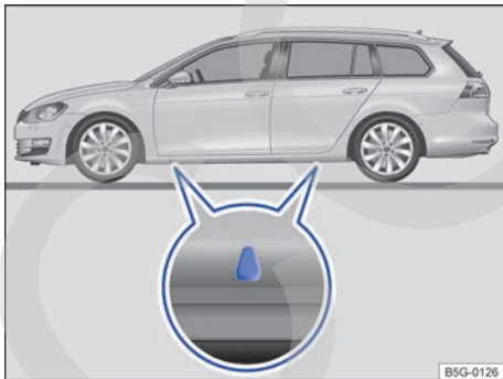
Fig. 214 Puntos de apoyo para el gato. ▶
