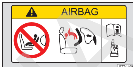
Fig. 23 Etiqueta adhesiva relativa al airbag en el parasol (representación esquemática).
