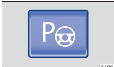
Fig. 132 En la parte inferior de la consola central: tecla para conectar el sistema de aparcamiento asistido.
