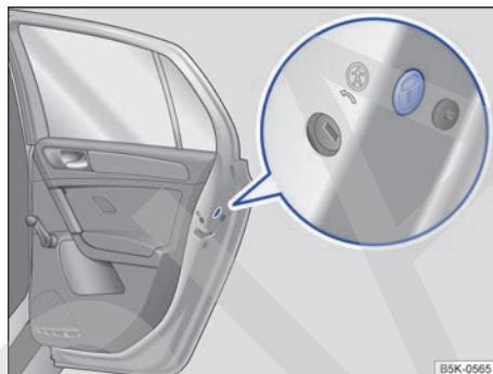
Fig. 67 En el frontal de la puerta trasera derecha: bloqueo de emergencia cubierto por una junta de goma.
