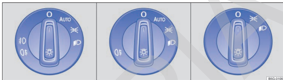
Fig. 86 Junto al volante: representación de algunos tipos de mandos de luces.
