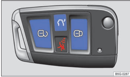
Fig. 52 Llave del vehículo (en función del equipamiento con tecla de alarma).
