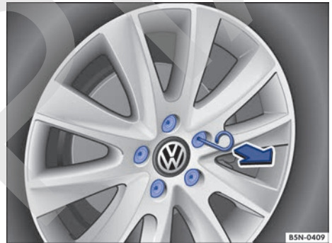
Fig. 211 Quitar los capuchones de los tornillos de rueda.
