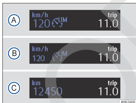
Fig. 123 En la pantalla del cuadro de instrumentos: indicaciones del estado del limitador de velocidad (en función del equipamiento).
