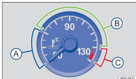
Fig. 43 En el cuadro de instrumentos: indicador de la temperatura del líquido refrigerante del motor (representación esquemática).
