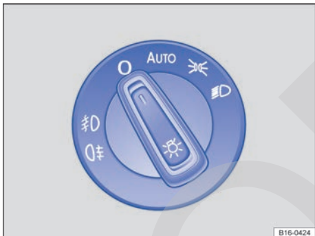
Fig. 89 Junto al volante: mando de las luces (una variante).
