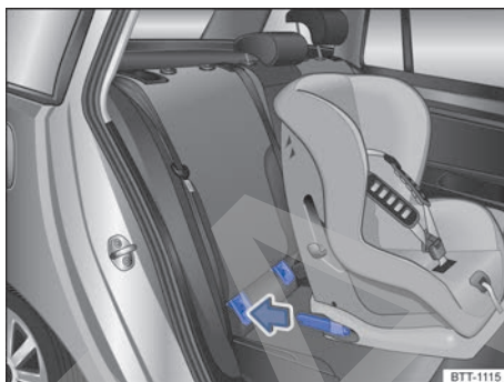
Fig. 23 Montaje de un asiento para niños ISOFIX con conectores (representación esquemática).
