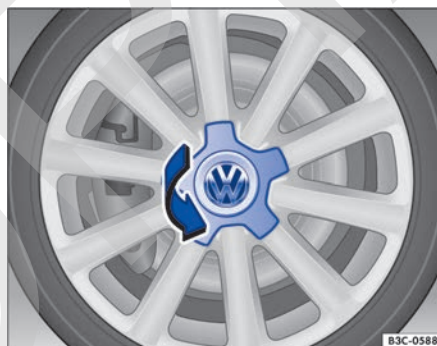
Fig. 227 Desmontar el tapacubos central girándolo.
