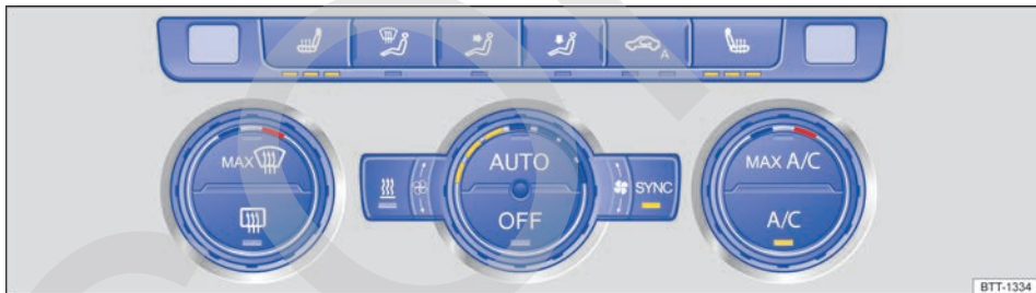
Fig. 105 En la parte superior de la consola central: mandos del Climatronic.
