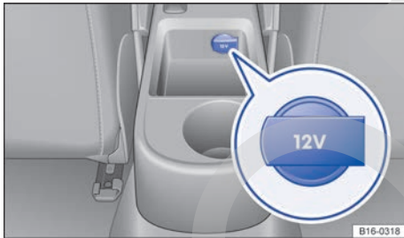
Fig. 170 Toma de corriente de 12 voltios en la consola central: variante 1.
