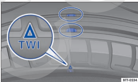
Fig. 223 Perfil del neumático: indicadores de desgaste.
