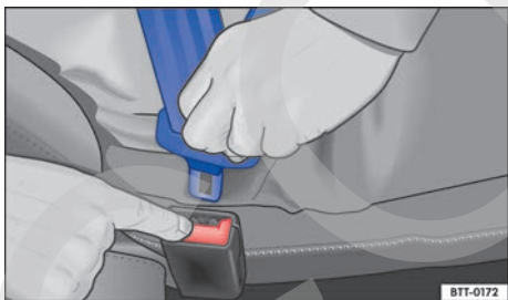
Fig. 9 Soltar la lengüeta del cierre del cinturón.
