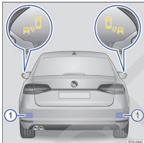
Fig. 138 Vista trasera del vehículo: zonas de los sensores de radar e indicaciones del detector de ángulo muerto.
