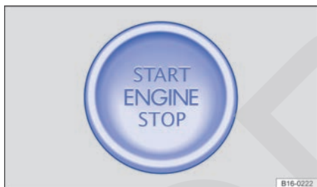
Fig. 114 En la parte inferior de la consola central: pulsador de encendido y arranque para poner el motor en marcha.
