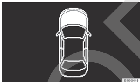
Fig. 209 En la pantalla del cuadro de instrumentos: capó del motor abierto o no cerrado correctamente (variante 1).
