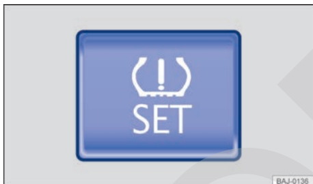
Fig. 219 En la guantera: tecla del sistema de control de los neumáticos.
