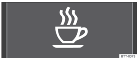
Fig. 41 En la pantalla del cuadro de instrumentos: símbolo de detección del cansancio.
