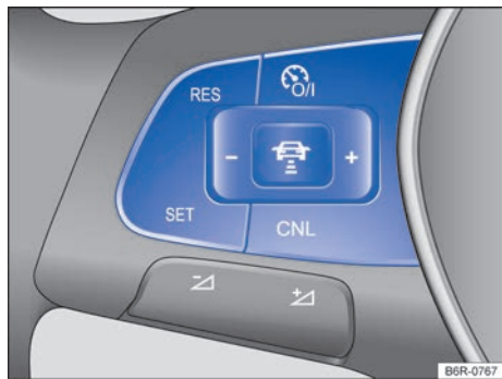
Fig. 132 Lado izquierdo del volante multifunción: teclas para manejar el ACC.
