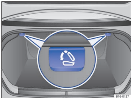
Fig. 81 En el maletero: palancas de desbloqueo de los respaldos del asiento trasero.
