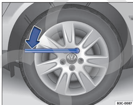
Fig. 230 Cambio de rueda: aflojar los tornillos de rueda.
