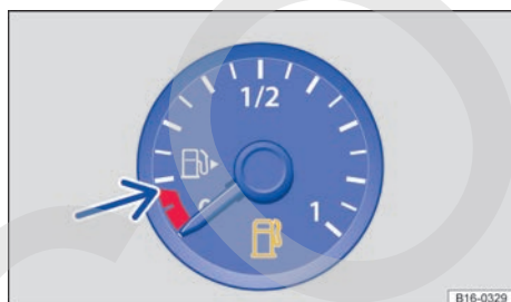
Fig. 42 En el cuadro de instrumentos: indicador del nivel de combustible (variante 1).
