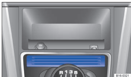
Fig. 157 En la parte inferior de la consola central: portatarjetas.
