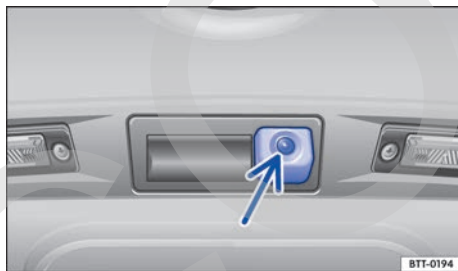
Fig. 153 En el portón del maletero: ubicación de la cámara del asistente de marcha atrás.
