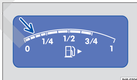
Fig. 43 En la pantalla del cuadro de instrumentos: indicador del nivel de combustible (variante 2).
