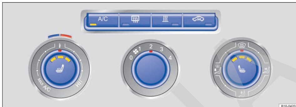
Fig. 103 En la parte superior de la consola central: mandos del climatizador manual (variante 1).
