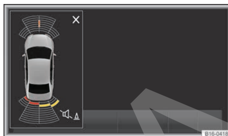
Fig. 147 Visualización periférica reducida del ParkPilot en la pantalla (a color) (representación esquemática).
