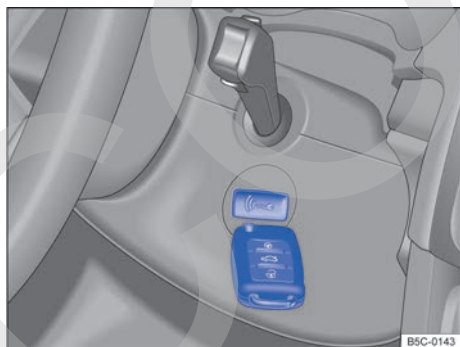
Fig. 115 En el lado derecho de la columna de dirección: función de arranque de emergencia en vehículos con el sistema de cierre y arranque sin llave Keyless Access.
