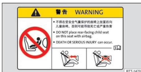
Fig. 21 Etiqueta adhesiva relativa al airbag en el parascal (representación esquemática).
