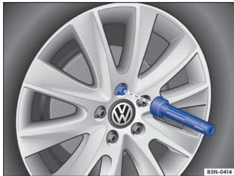
Fig. 236 Cambio de rueda: desenroscar los tornillos de rueda con el mango del destornillador.
