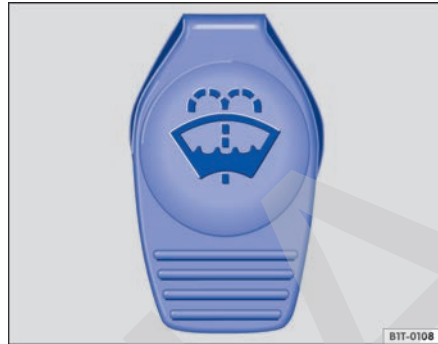
Fig. 211 En el vano motor: tapa del depósito del lavacristales.
