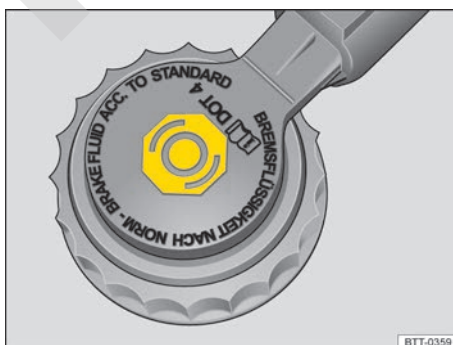
Fig. 216 En el vano motor: tapa del depósito del líquido de frenos (representación esquemática).
