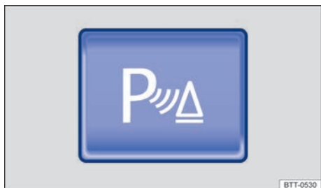
Fig. 145 En la consola central: tecla para conectar y desconectar el ParkPilot (en función del equipamiento).
