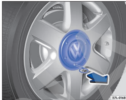
Fig. 226 Desmontar el tapacubos central tirando de él.
