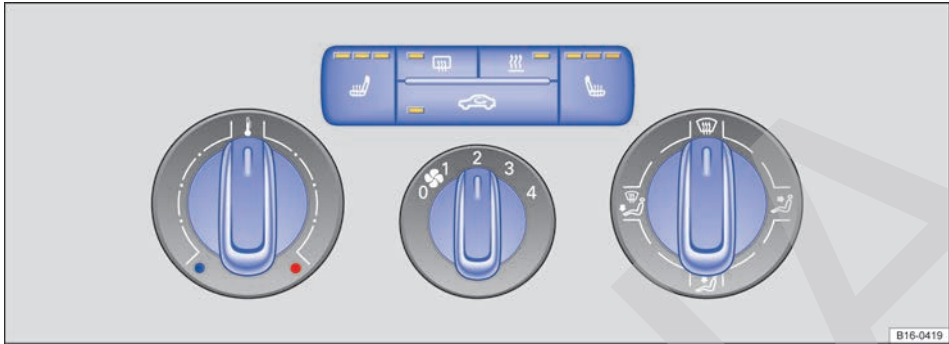
Fig. 106 En la parte superior de la consola central: mandos del sistema de calefacción y ventilación.
