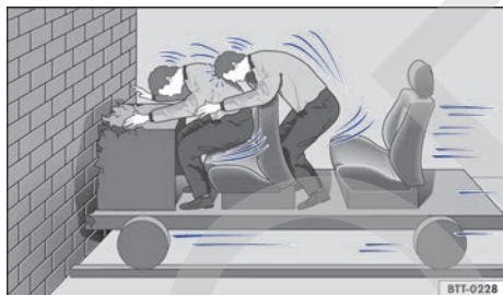
Fig. 4 El vehículo choca contra el muro. Los ocupantes no llevan colocado el cinturón de seguridad.
