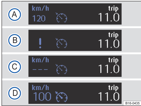
Fig. 126 En la pantalla del cuadro de instrumentos: indicaciones del estado del GRA.
