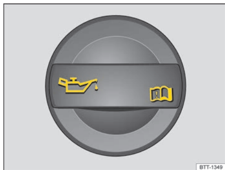
Fig. 213 En el vano motor: tapa de la boca de llenado de aceite del motor (representación esquemática).
