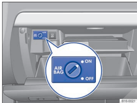
Fig. 16 En la guantera: conmutador de llave para activar y desactivar el airbag frontal del acompañante.
