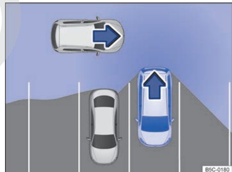
Fig. 141 Asistente de salida del aparcamiento: zona vigilada alrededor del vehículo que está desapareciendo (representación esquemática).
