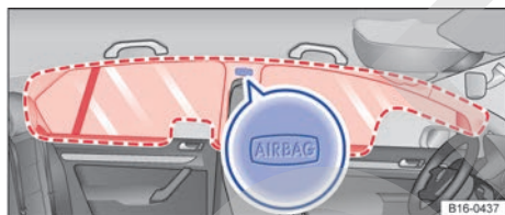
Fig. 19 En el lado izquierdo del vehículo: ubicación y zona de despliegue del airbag para la cabeza.
