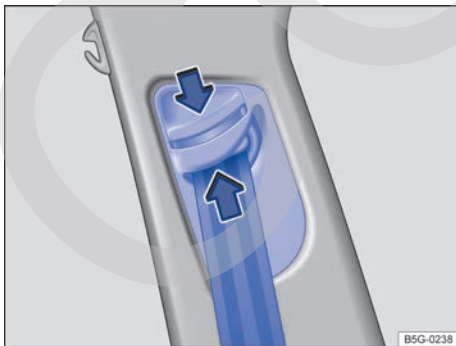
Fig. 12 Junto a los asientos delanteros: regulador de la altura del cinturón.
