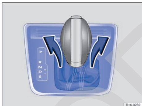
Fig. 124 Desmontar la cubierta de la corredera de la palanca selectora.
