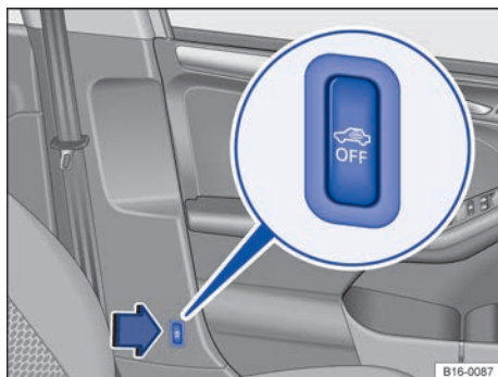
Fig. 54 Junto al asiento del conductor: tecla para desconectar la vigilancia del habitáculo y el sistema antirremolcado.
