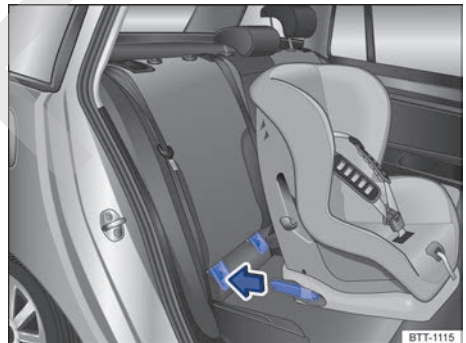
Fig. 27 Representación esquemática: montaje de un asiento para niños ISOFIX con conectores.
