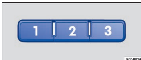
Fig. 95 En el revestimiento interior del techo: teclas del mando para apertura del garaje.
