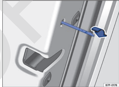
Fig. 82 En el frontal de la puerta trasera derecha: bloqueo de emergencia del vehículo con la llave de emergencia.
