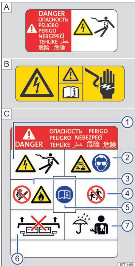
Fig. 272 Letreros de advertencia (representaciones esquemáticas): A) Componentes de alto voltaje. B) Letrero de advertencia general de alto voltaje. C) Letrero de advertencia de la batería de alto voltaje.
