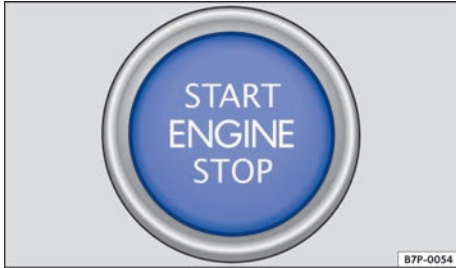
Fig. 143 Sistema de cierre y arranque sin llave Keyless Access: pulsador de encendido y arranque.
