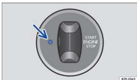
Fig. 72 Cerradura de encendido: desbloqueo de emergencia de la llave.
