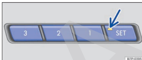
Fig. 112 En la parte superior del guarnecido de las puertas del conductor y del acompañante: teclas de memoria para los ajustes del asiento.
