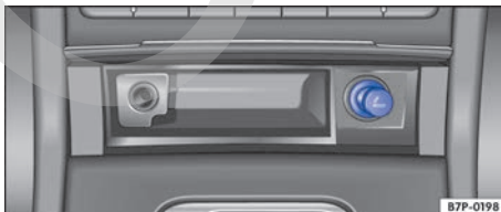
Fig. 210 En la parte delantera de la consola central: encendedor.
