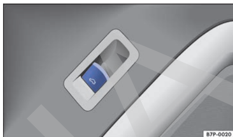
Fig. 85 En la puerta del conductor: tecla de desbloqueo del portón del maletero.
