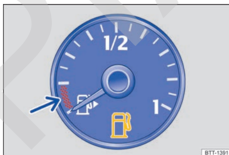
Fig. 51 En el cuadro de instrumentos: indicador del nivel de gasolina o gasóleo.
