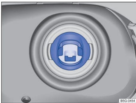
Fig. 238 Representación esquemática: protección en la boca de llenado del depósito de combustible para no repostar equivocadamente.
