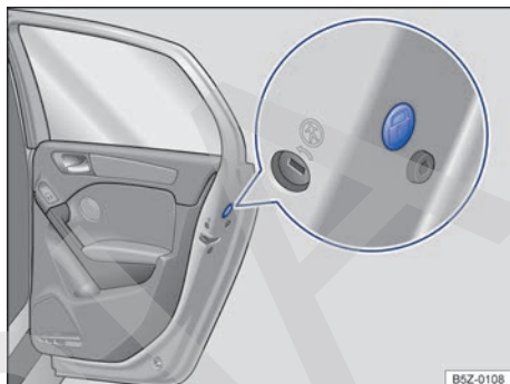
Fig. 152 En la puerta trasera: cierre de emergencia, cubierto por una junta de goma.
