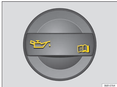
Fig. 129 En el compartimento del motor: tapón de la boca de llenado del aceite del motor.
