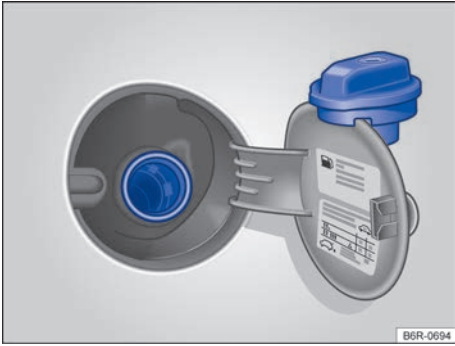
Fig. 125 Puerta del depósito de combustible abierta con la tapa del depósito de combustible colgada.
