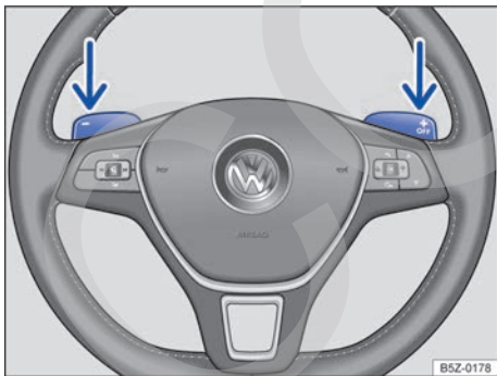
Fig. 103 Volante con dos levas para cambiar de marcha en modo manual.
