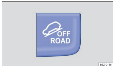
Fig. 112 En la consola central: tecla para activar y desactivar el modo off-road de forma manual.
