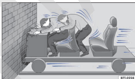
Fig. 42 Un vehículo con los ocupantes del vehículo sin cinturones de seguridad choca con el muro.
