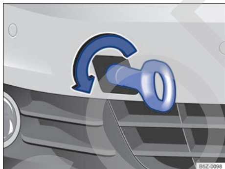
Fig. 185 En el parachoques delantero a la derecha: enrosque la argolla de remolque.
