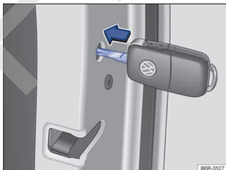
Fig. 153 Cierre de emergencia del vehículo con la llave del vehículo.
