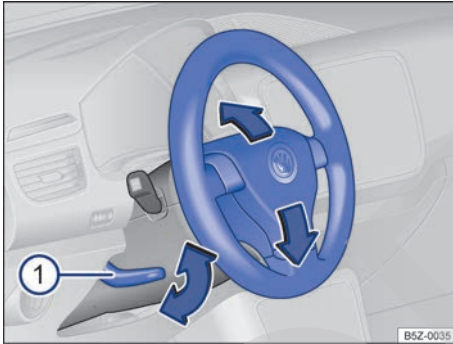
Fig. 39 Ajuste de la posición del volante mecánicamente.
