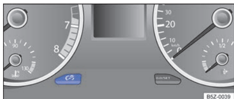
Fig. 59 En el panel de instrumentos: tecla de regulación de la iluminación de los instrumentos y de los interruptores.
