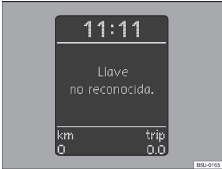
Fig. 93 En el panel de instrumentos: display con indicación del inmovilizador activado - vehículos con Sistema de Informaciones Volkswagen.
