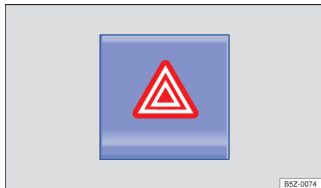
Fig. 146 En la parte superior de la consola central: interruptor de encender y apagar las luces de advertencia.
