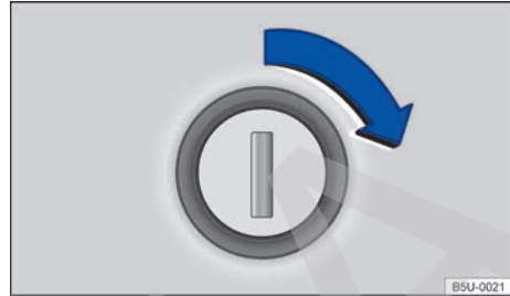
Fig. 27 Tapa del maletero: abra la tapa desde cilindro de la cerradura.
