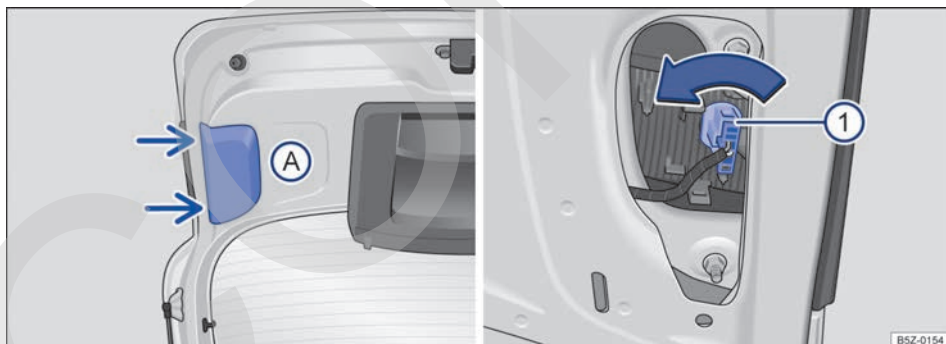
Fig. 178 En la tapa del maletero: desmonte la cubierta de la lámpara de la linterna trasera derecha y/o la linterna trasera izquierda - para vehículos sin linterna de neblina. ▶
