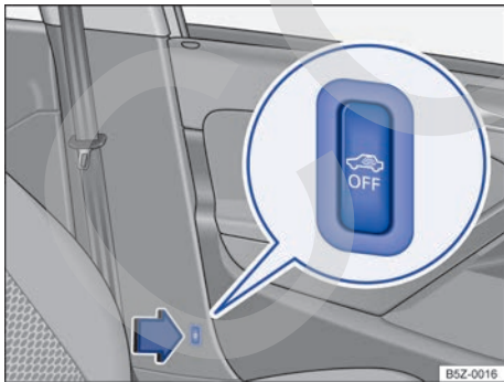
Fig. 26 Al lado del asiento del conductor: la tecla para desconectar el monitoreo del interior del vehículo.
