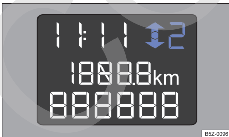
Fig. 99 En el panel de instrumentos : indicador de cambio de marcha (variante 2).
