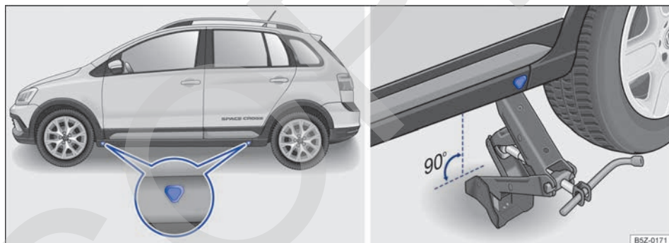
Fig. 163 Puntos de apoyo del gato y gato posicionado atrás en el lado izquierdo trasero del vehículo.
