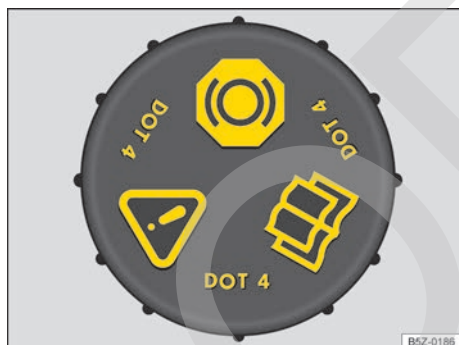
Fig. 110 En el compartimento del motor: tapón de cierre del depósito del líquido de frenos (variante 2).
