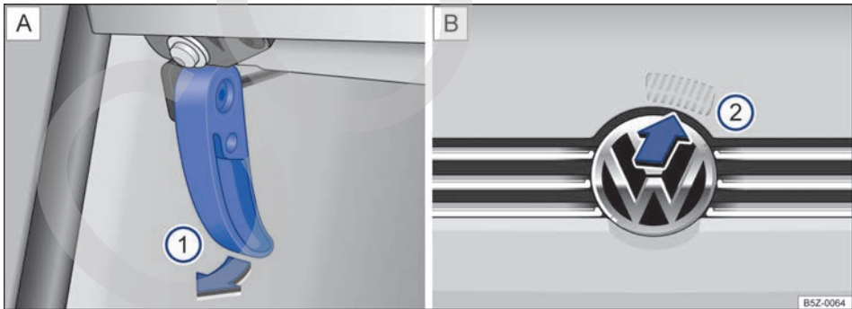
Fig. 126 A: palanca de desbloqueo en la zona reposapiés del lado del conductor ①. B: palanca de desbloqueo en la parte interior de la tapa del compartimento del motor ②.
