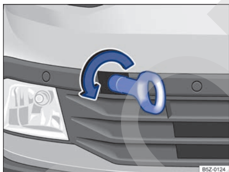
Fig. 187 En el parachoques delantero a la derecha: enrosque la argolla de remolque.
