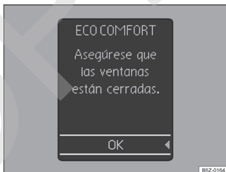
Fig. 14 En el panel de instrumentos: texto de advertencia del ECO Comfort.
