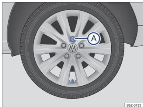
Fig. 160 Retire el tapacubos integral.
