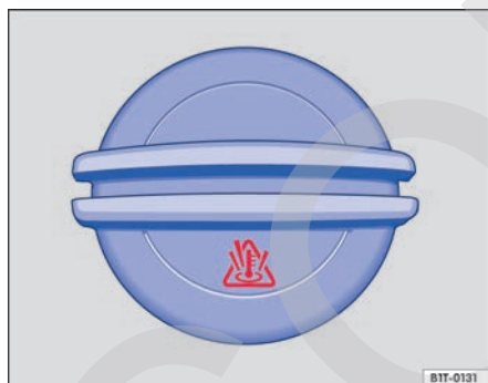
Fig. 132 En el compartimento del motor: tapón del depósito de expansión del líquido refrigerante de motor.
