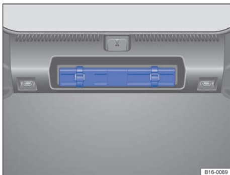
Fig. 211 En el maletero: soporte para el triángulo de preseñalización.
