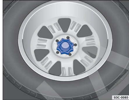
Fig. 204 En el maletero: ruedecilla para fijación de la rueda de repuesto.
