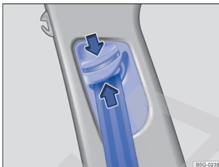
Fig. 73 Junto a los asientos delanteros: regulador de la altura del cinturón.
