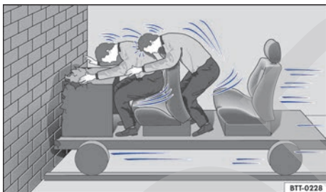
Fig. 65 El vehículo choca contra el muro. Los ocupantes no llevan colocado el cinturón de seguridad.
