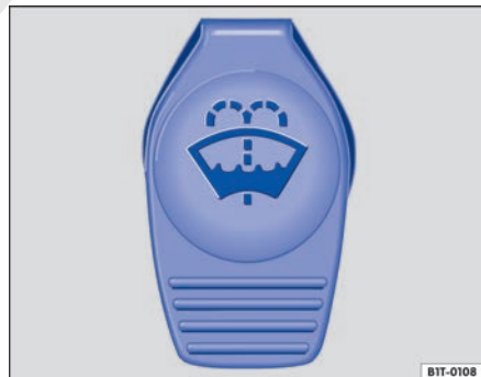
Fig. 97 En el vano motor: tapa del depósito de lavacrystal. ▶
