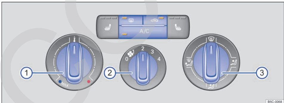
Fig. 179 En la parte superior de la consola central: mandos del climatizador manual.
