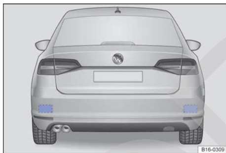
Fig. 171 Vista trasera del vehículo: zonas de los sensores de radar.
