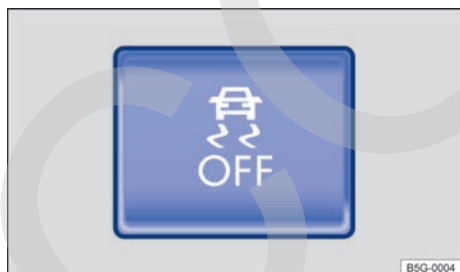
Fig. 144 En la parte inferior de la consola central: tecla para desconectar y conectar manualmente el ASR (en función del modelo).
