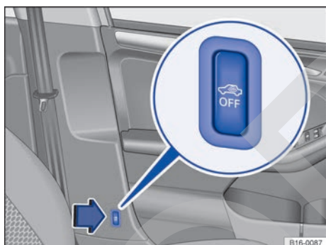
Fig. 36 Junto al asiento del conductor: tecla para desconectar la vigilancia del habitáculo y el sistema antirremolcado.
