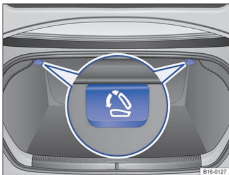
Fig. 61 En el maletero: palancas de desbloqueo de los respaldos del asiento trasero.
