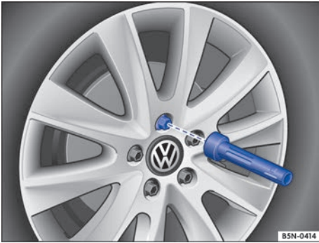
Fig. 233 Cambio de rueda: desenroscar los tornillos de rueda con el mango del destornillador.
