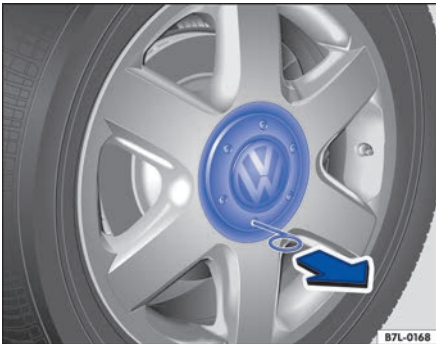
Fig. 223 Desmontar el tapacubos central.
