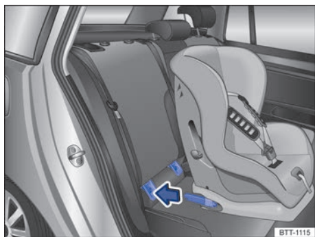
Fig. 85 Montaje de un asiento para niños ISOFIX con conectores utilizando guías de inserción (representación esquemática).
