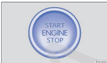
Fig. 132 En la parte inferior de la consola central: pulsador de arranque del sistema de cierre y arranque Keyless Access.
