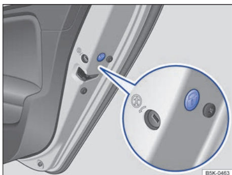
Fig. 213 En el frontal de la puerta trasera derecha: bloqueo de emergencia cubierto por una junta de goma.
