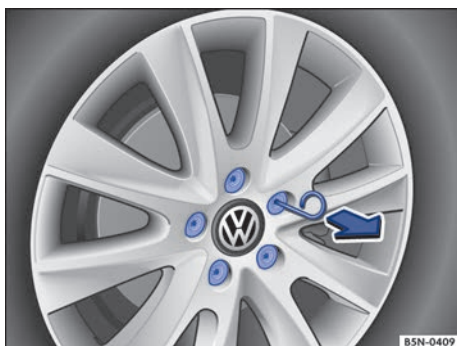
Fig. 226 Quitar los capuchones de los tornillos de rueda.
