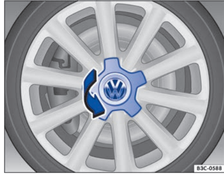
Fig. 224 Desenroscar el tapacubos central.
