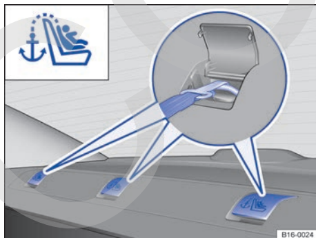
Fig. 86 En la bandeja trasera detrás del respaldo del asiento trasero: argollas de sujeción para el cinturón de fijación superior.
