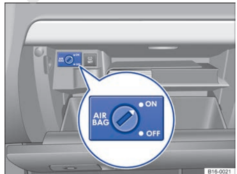
Fig. 77 En la guantera: conmutador de llave para activar y desactivar el airbag frontal del acompañante.
