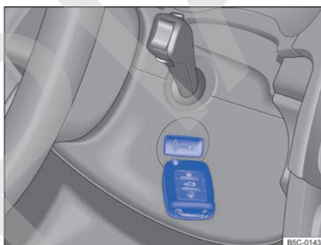
Fig. 133 En el lado derecho de la columna de dirección: función de arranque de emergencia en vehículos con el sistema Keyless Access.
