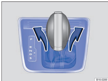
Fig. 219 Desmontar la cubierta de la corredera de la palanca selectora.
