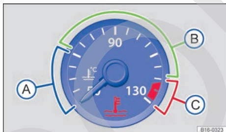
Fig. 194 Indicador de la temperatura del líquido refrigerante del motor: (A) zona fría; (B) zona normal; (C) zona de advertencia.
