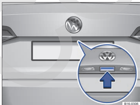
Fig. 41 Apertura del portón del maletero desde el exterior.
