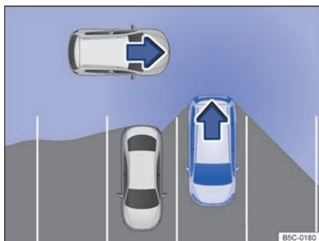
Fig. 174 Asistente de salida del aparcamiento: zona vigilada alrededor del vehículo que está desaparcando (representación esquemática).
