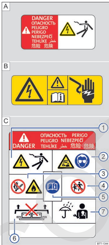
Fig. 18 Letreros de advertencia: A ) Componentes de alto voltaje. B ) Letrero de advertencia general de alto voltaje. C ) Letrero de advertencia de la batería de alto voltaje (representaciones esquemáticas).
