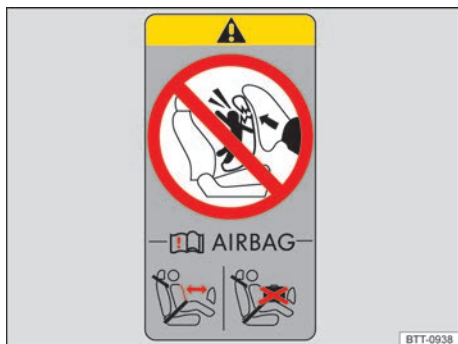
Fig. 82 Etiqueta adhesiva relativa al airbag en el pilar B (representación esquemática).
