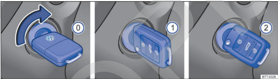
Fig. 131 Posiciones de la llave del vehículo en la cerradura de encendido.
