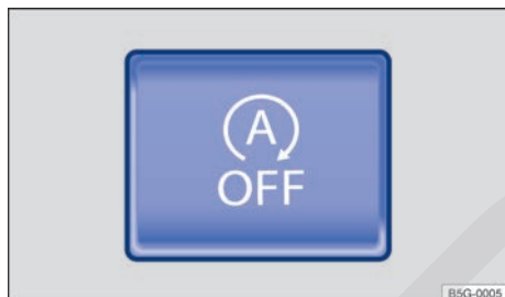
Fig. 147 En la parte inferior de la consola central: tecla del sistema Start-Stop.
