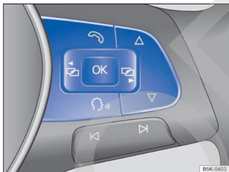
Fig. 14 Lado derecho del volante multifunción: teclas para utilizar los menús y las indicaciones informativas del cuadro de instrumentos.
