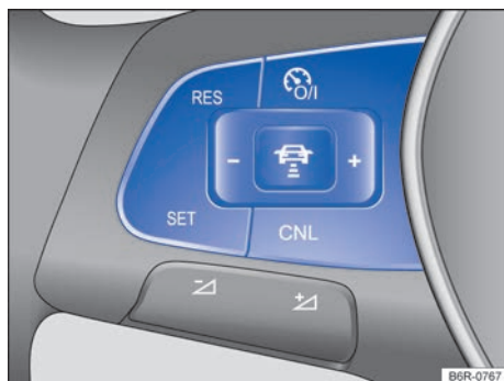
Fig. 164 Lado izquierdo del volante multifunción: teclas para manejar el control de cruceo adaptativo.
