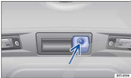
Fig. 155 En el portón del maletero: ubicación de la cámara del asistente de marcha atrás.
