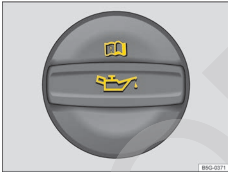
Fig. 193 En el vano motor: tapa de la boca de llenado de aceite (representación esquemática).
