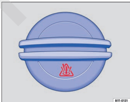
Fig. 196 En el vano motor: tapa del depósito de expansión del líquido refrigerante del motor.
