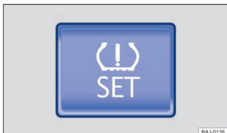
Fig. 199 En la guantera: tecla del sistema de control de los neumáticos.
