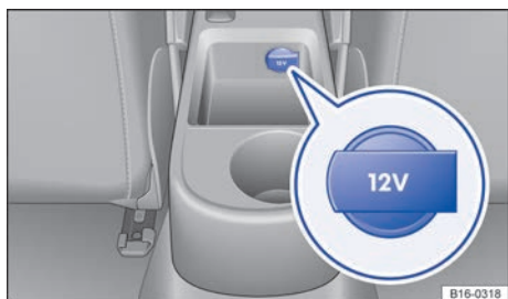
Fig. 127 Toma de corriente de 12 voltios en la consola central: variante 1.
