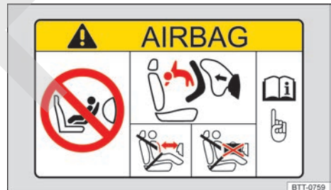
Fig. 81 Etiqueta adhesiva relativa al airbag en el parasol (representación esquemática).
