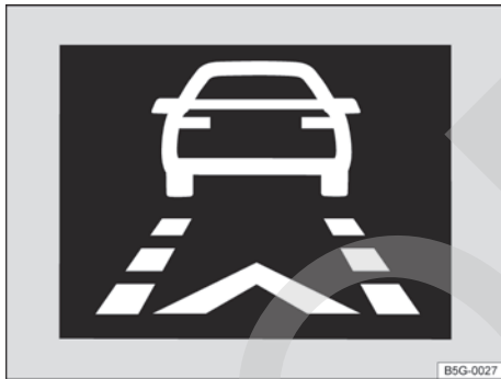
Fig. 168 En la pantalla del cuadro de instrumentos: indicación del preaviso.
