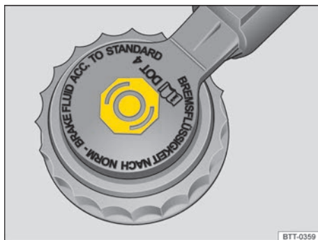
Fig. 145 En el vano motor: tapa del depósito del líquido de frenos.
