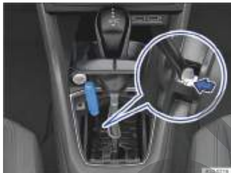
Fig. 98 Realizar un desbloqueo de emergencia de la palanca selectora (variante 1).
