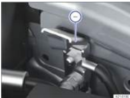
Fig. 157 En el vano motor: toma para la ayuda de arranque, masa.
