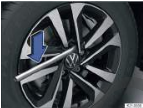
Fig. 192 Cambio de rueda: desenroscar los tornillos de rueda con la llave de rueda.
