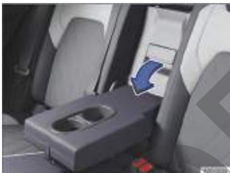
Fig. 137 Trampilla para cargas largas en el respaldo del asiento trasero (representación esquemática).
