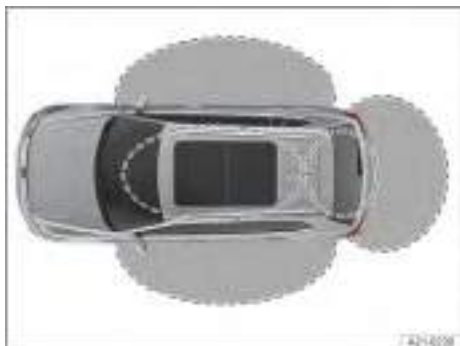
Fig. 48 Sistema "Keyless Access": zonas de proximidad (representación esquemática).
