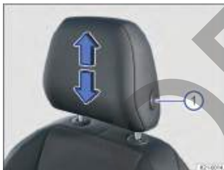
Fig. 67 Representación esquemática: ajuste de los apoyacabezas delanteros.
