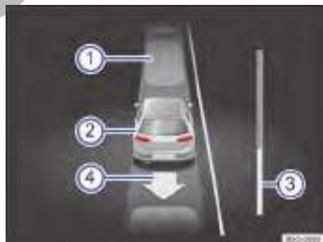
Fig. 126 En la pantalla del cuadro de instrumentos: desaparcar marcha atrás de un hueco en línea.
