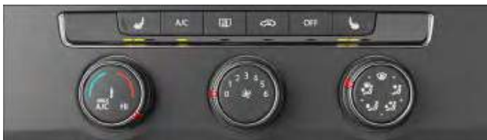
Fig. 88 En la parte superior de la consola central: panel de mandos del climatizador manual.
