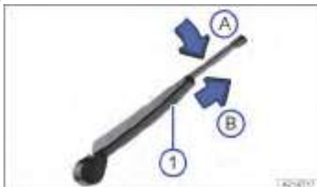
Fig. 149 Cambiar la escobilla limpiacristales de la luneta.
