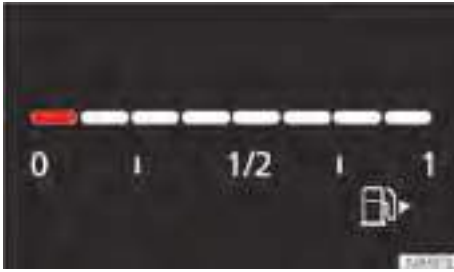
Fig. 16 Indicador del nivel de combustible en el cuadro de instrumentos digital Basic (representación esquemática).
