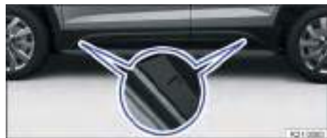
Fig. 189 Puntos de apoyo para el gato.
