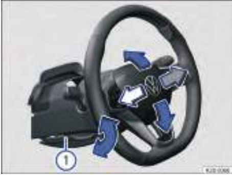
Fig. 61 Debajo del volante, en el garnecido de la columna de dirección: palanca para el ajuste manual de la posición del volante (representación esquemática).
