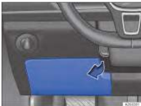
Fig. 153 En el lado izquierdo, junto al volante: tapa de la caja de fusibles del tablero de instrumentos (representación esquemática).
