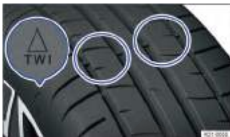
Fig. 180 Perfil del neumático: indicadores de desgaste.
