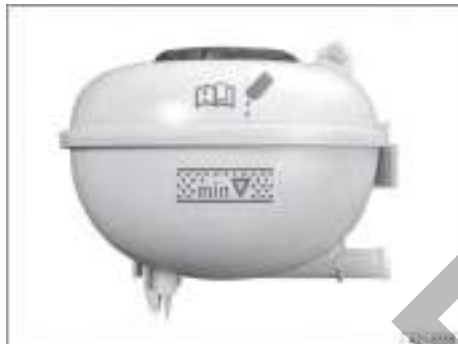
Fig. 174 En el vano motor: marcas en el depósito de expansión del líquido refrigerante del motor (representación esquemática).
