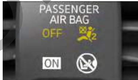
Fig. 32 En la consola central: testigo de control de la desactivación del airbag frontal del acompañante (en función del país).
