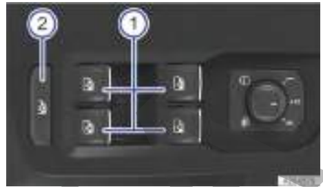
Fig. 59 En la puerta del conductor: teclas de los elevavinas.
