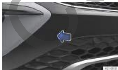
Fig. 159 En el lado derecho del paragolpes delantero: retirar la tapa.
