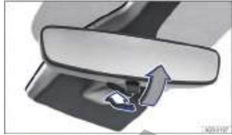
Fig. 82 En el parabrisas: retrovisor interior antideslumbrante manual.
