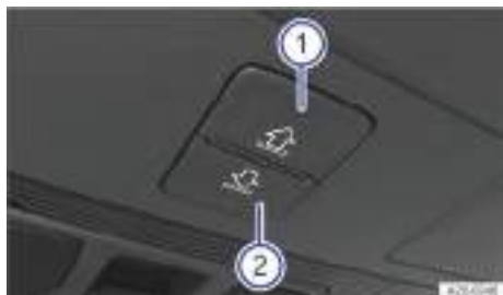
Fig. 85 En el revestimiento interior del techo: teclas para manejar la cortinilla parasol.
