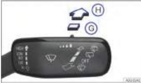
Fig. 79 En el lado derecho de la columna de dirección: manejo del limpiaventana.
