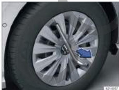
Fig. 182 Desmontar el tapacubos integral.
