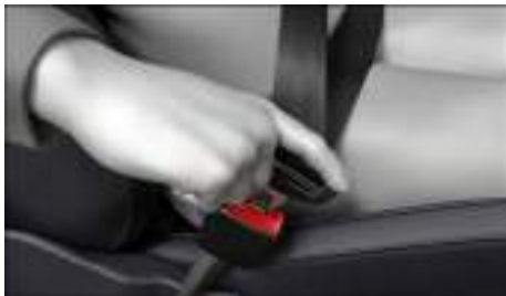
Fig. 23 Insertar la lengüeta del cinturón de seguridad en su cierre.
