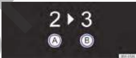
Fig. 90 En la pantalla del cuadro de instrumentos: recomendación de marcha.
