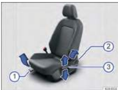
Fig. 63 En el asiento del conductor: mandos.
