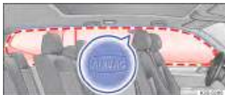
Fig. 35 A ambos lados del vehículo: ubicación y zona de despliegue del airbag para la cabeza.
