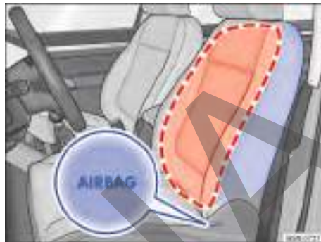
Fig. 33 En el lateral de ambos asientos delanteros: ubicación y zona de despliegue del airbag lateral.
