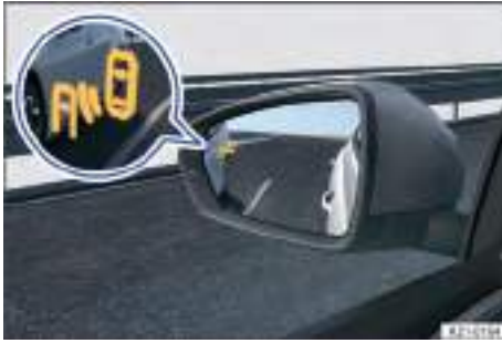
Fig. 118 En los retrovisores exteriores: indicación del detector de ángulo muerto.
