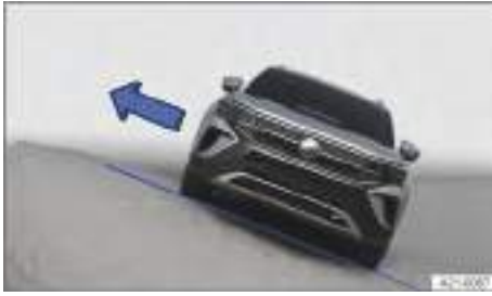
Fig. 104 Representación esquemática: bajar del vehículo siempre por el lado que mira a la cima.
