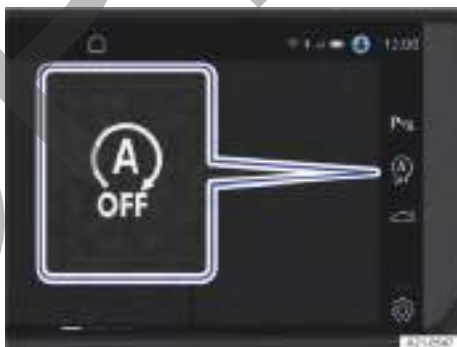
Fig. 94 En el sistema de infotainment: botón de función del sistema Start-Stop.
