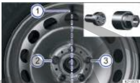
◀ Fig. 185 Cambio de rueda: válvula del neumático ① y lugares de montaje del tornillo de rueda antirrobo ② o ③.
