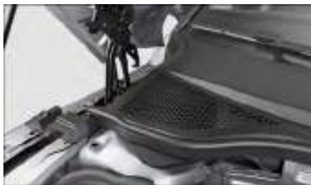
Fig. 195 Entre el vano motor y el parabrisas: caja de aguas (representación esquemática).
