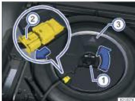
Fig. 187 En el maletero: desmontar el subwoofer (variante 2).
