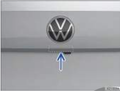
Fig. 55 En el portón trasero: pulsador para abrir el portón (representación esquemática).
