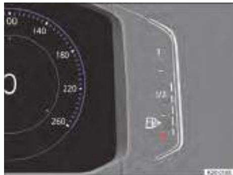
Fig. 15 Indicador del nivel de combustible en el cuadro de instrumentos digital Pro (representación esquemática).
