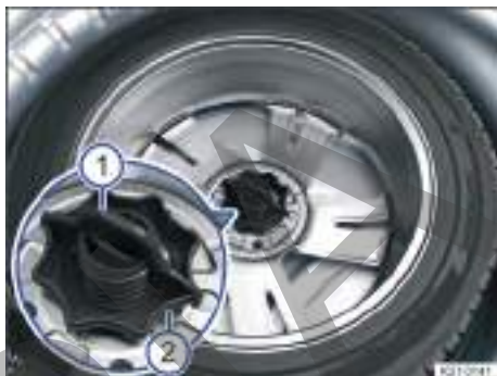
Fig. 188 En el maletero: ruedecilla para fijar la rueda de repuesto.
