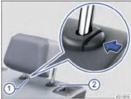
Fig. 70 Representación esquemática: desmontaje de los apoyacabezas traseros.
