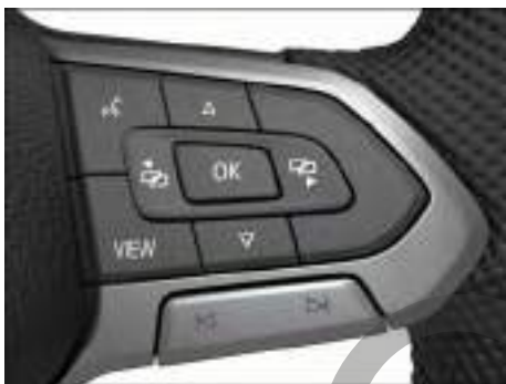
Fig. 13 Lado derecho del volante multifunción: manejo del cuadro de instrumentos digital Basic (variante 1).
