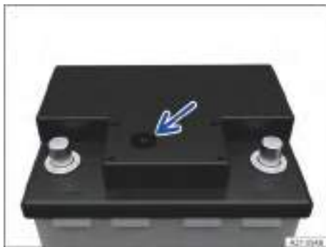
Fig. 176 En la parte superior de la batería de 12 voltios: mirilla (representación esquemática).
