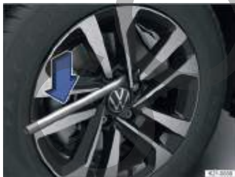
Fig. 184 Cambio de rueda: aflojar los tornillos de rueda.
