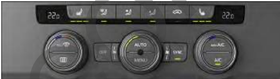
Fig. 87 En la parte superior de la consola central: panel de mandos del Climatronic (variante 2).
