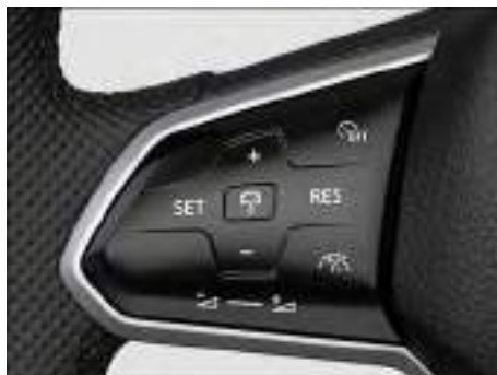
Fig. 106 Lado izquierdo del volante multifunción (variante 2).
