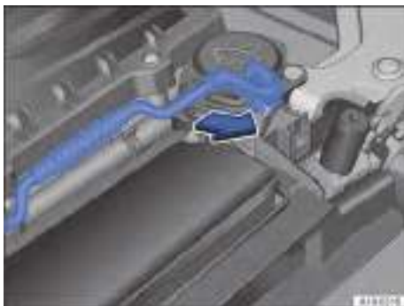
Fig. 165 En el vano motor: varilla de sujeción del capó en su soporte.
