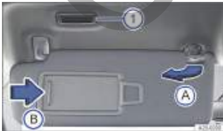
Fig. 84 En el revestimiento interior de la parte delantera del techo: parasol.
