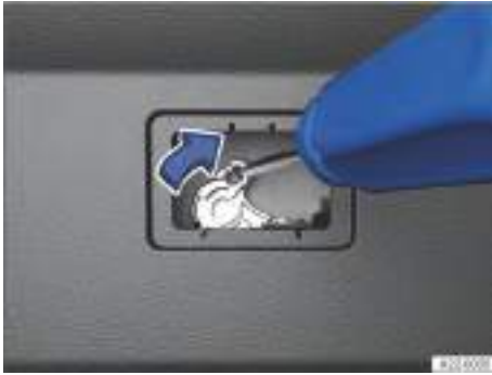
Fig. 58 En el maletero: desbloqueo de emergencia del portón.
