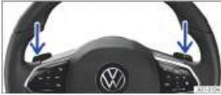
Fig. 97 Volante con levas de cambios para el Tiptronic.
