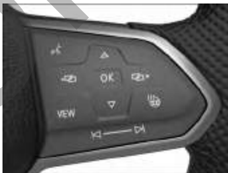
Fig. 11 Lado derecho del volante multifunción: manejo del cuadro de instrumentos digital Pro (variante 2).
