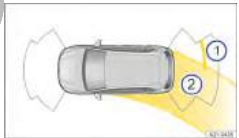
Fig. 120 Sistema de infotainment: ayuda de aparcamiento con detección de obstáculos y giro del volante (representación esquemática).
