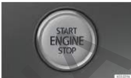
Fig. 92 En la parte inferior de la consola central: pulsador de encendido y arranque para poner el motor en marcha.
