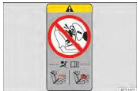
Fig. 38 Representación esquemática: etiqueta adhesiva relativa al airbag en el pilar B.
