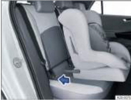
Fig. 39 Representación esquemática: montaje de un asiento para niños con conectores.
