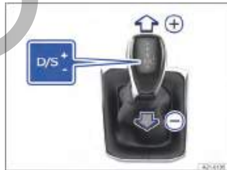
Fig. 96 Palanca selectora en la posición Tiptronic.
