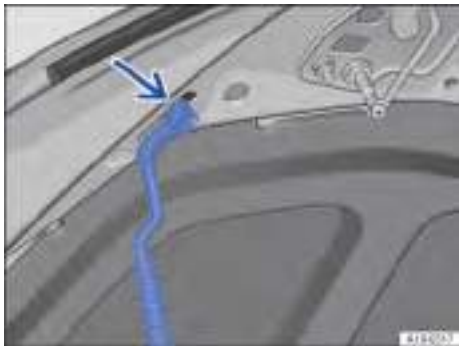
Fig. 166 En el capó delantero: alojamiento de la varilla de sujeción del capó (representación esquemática).
