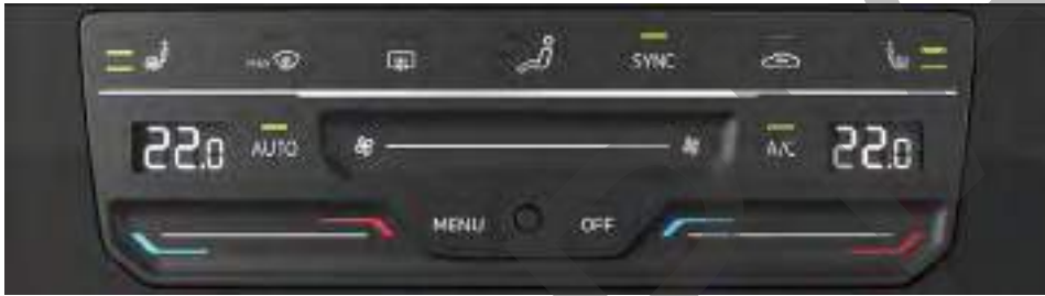
Fig. 86 En la parte superior de la consola central: panel de mandos del Climatronic (variante 1).
