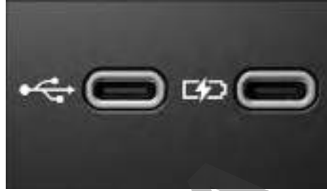
Fig. 130 Conexión USB-C disponible en el vehículo (representación estándar).
