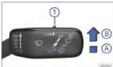
Fig. 80 En el lado derecho de la columna de dirección: palanca del limpiacristales.
