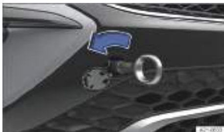
Fig. 160 En el lado derecho del paragolpes delantero: enroskar la argolla de remolque.
