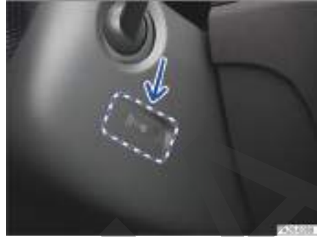
Fig. 93 En el lado derecho de la columna de dirección: función de arranque de emergencia.
