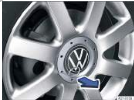
Fig. 181 Desmontar el tapacubos central tirando de él.
