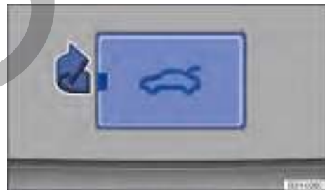
Fig. 57 En el portón trasero: tapa del desbloqueo de emergencia del portón.
