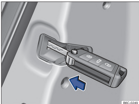
Fig. 59 En las puertas, delantera derecha y traseras: bloqueo de emergencia del vehículo con la varilla metálica de la llave.
