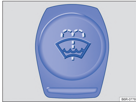
Fig. 183 En el compartimento del motor: tapón de cierre del depósito de agua de los lavacrystales.
