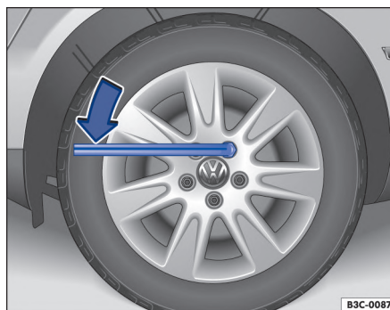
Fig. 199 Cambio de rueda: aflojar los tornillos de la rueda.
