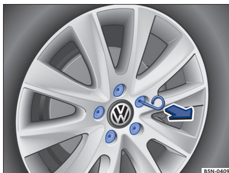
Fig. 198 Retirar las caperuzas de los tornillos de la rueda.
