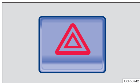
Fig. 49 En la parte superior de la consola central: interruptor de las luces de advertencia.
