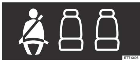
Fig. 25 Indicador de estatus del cinturón de seguridad para los asientos traseros en el display del instrumento combinado.
