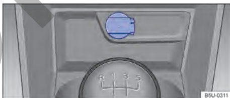
Fig. 93 En la consola central delantera: toma de corriente de 12 V.
