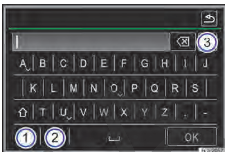
Fig. 98 Representación del principio: máscara de inserción con teclado de display.
