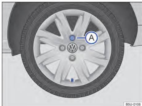
Fig. 184 Cambio de rueda: secuencia de desmontaje de los tornillos de la rueda.
