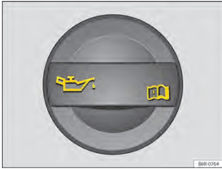
Fig. 168 En el compartimento del motor: tapón de la boca de llenado del aceite del motor.
