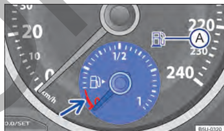
Fig. 13 En el instrumento combinado: indicador del nivel de combustible (variante 2).
