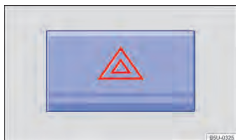
Fig. 40 En la parte superior de la consola central: in- terruptor de las luces de advertencia.
