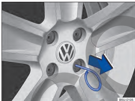
Fig. 180 Retirar las caperuzas de los tornillos de rueda.
