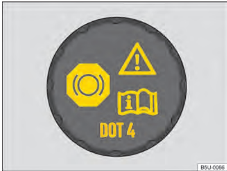
Fig. 171 En el compartimento del motor: tapón de cierre del depósito del líquido de frenos.
