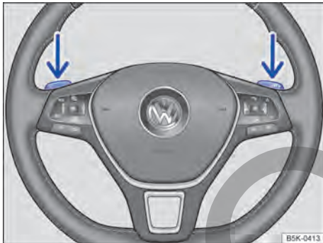
Fig. 83 Volante con selectores basculantes de Tiptronic.
