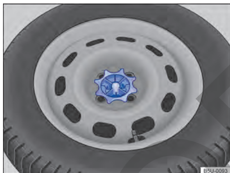
Fig. 178 En el maletero: manivela para fijación de la rueda de emergencia.
