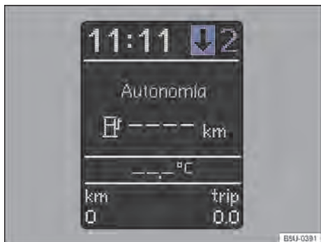
Fig. 76 En el panel de instrumentos : indicador de cambio de marcha (variante 2).
